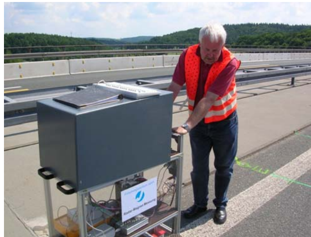
Abb. 5. Radar-Magnet-Messung auf der Schüpfbachtalbrücke.
