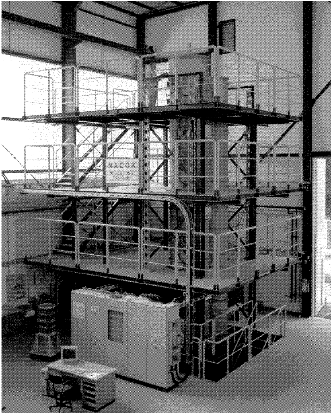
Abbildung 2.3: Photographie des Versuchsstands NACOK.
