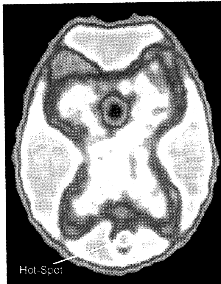
Abb. 32 ^{120}\text{gI} -PET-Aufnahme des 2-Kammer-Phantoms zur Simulation der weißen und grauen Hirnsubstanz. Der Hot-Spot in der unteren Bildhälfte ermöglicht die Auflösung verschiedener Positronenemitter zu vergleichen
