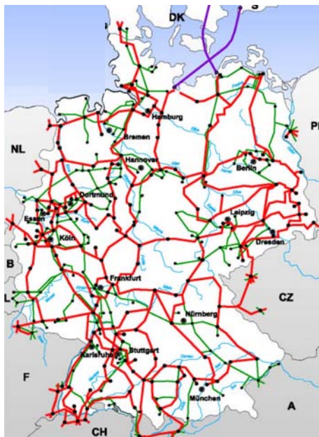
Abb. 5a: Stromverbundnetz (Haupttrassen)
