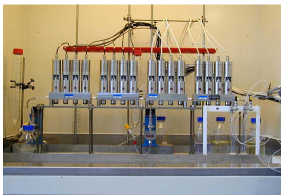
Abb. 4.1: Ein Batterie mit sechzehn Zentrifugalextraktoren, die im Forschungszentrum Jülich zum Einsatz kommen.
