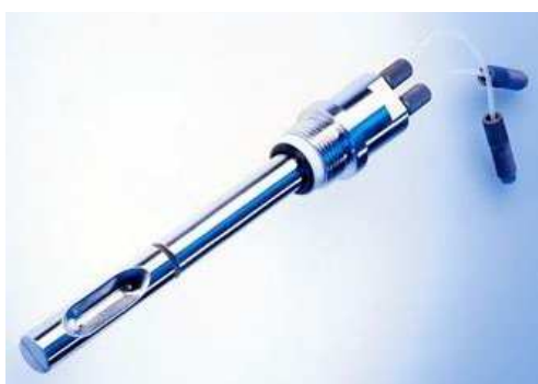
Abb. 4.8: Bild der Dialysesonde (Trace GmbH, Braunschweig) und schematische Darstellung des Funktionsprinzips der Dialysesonde
