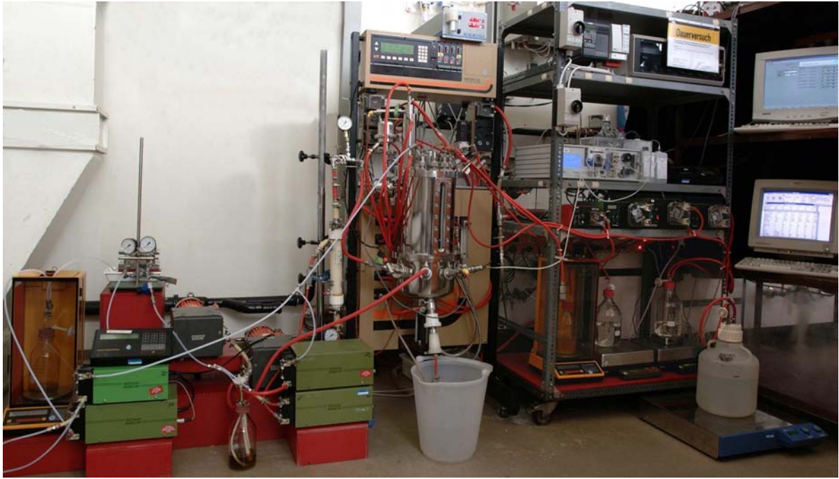
Abb. 4.15: Foto des 20 l Bioreaktors mit Peripherie und Umlauf zur Bereitstellung von proteinfreiem Permeat; das Permeat wurde von dort in die Zentrifugen zur Reaktivextraktion geleitet, zu sehen in Abb. 4.12
