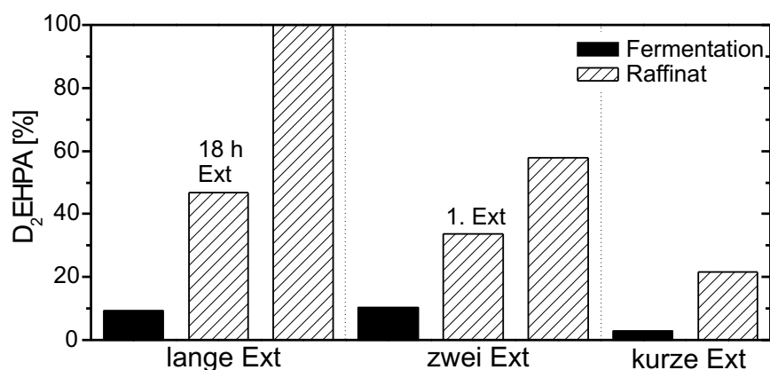
Abb. 7.20: Anteil an D 2 EHPA in der Fermentationsbrühe am Ende der Fermentationen mit integrierter Extraktion und im Raffinat; lange Extraktionsphase: D 2 EHPA im Raffinat nach 18 h Extraktion und am Ende der Extraktionsphase; zwei Extraktionsphasen: D 2 EHPA im Raffinat am Ende der 1. und der 2. Extraktionsphase; kurze Extraktionsphase: D 2 EHPA am Ende der Extraktionsphase
