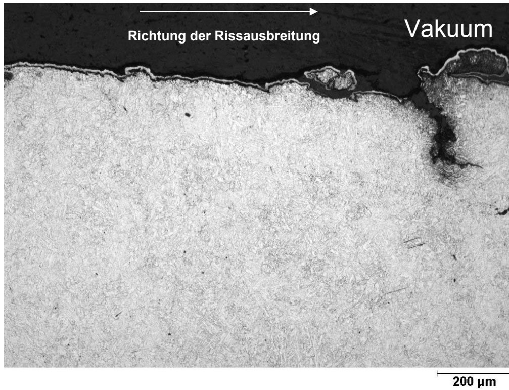
Abbildung 4.30: Lichtmikroskopische Aufnahme aus dem ERW-Versuch mit Haltezeit t_h=5\text{Min} , bei 550^\circ\text{C} , im Vakuum, Werkstoff P92
