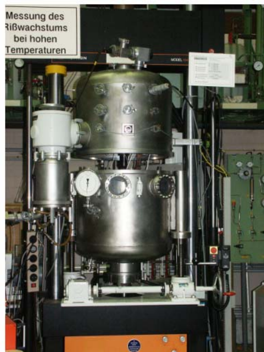
Abbildung 3.14: Versuchsaufbau für Experimente an CT-Proben in Prüfatmosphäre Vakuum und Luft (Typ I und Typ II-Prüfmaschinen)
