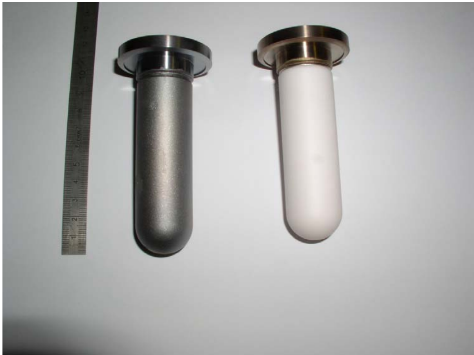
Abb. 4.17: Foto des kalten Keramikfensters mit Beschichtung (links) und ohne Beschichtung (rechts).
