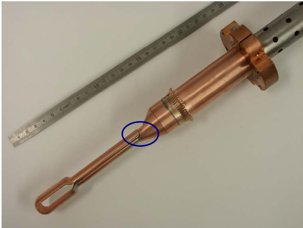
Abb. 4.23: Foto der Koppelschleife: Markiert ist der kritische Bereich beim Übergang der coaxialen Struktur zur Koppelschleife.
