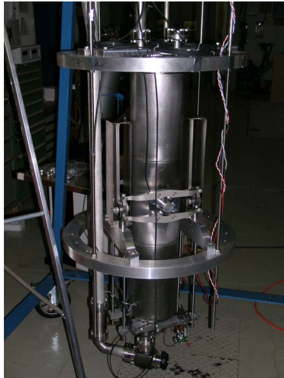
HWR inklusive Tuner im Test-Gestell
