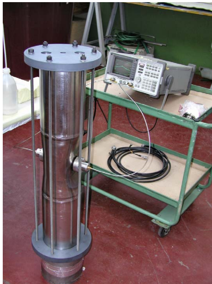
Abb. 7.1: Resonanzfrequenzmessungen (vor E-Beam Schweißung der Endkappen) zur Bestimmung der endgültigen Resonatorlänge.
