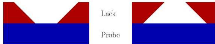
Abbildung 15: Lackkantenprofil beim Positivprozess (links) und beim Negativprozess (rechts). Für das Lift-Off-Verfahren ist das des Negativprozesses günstiger.
