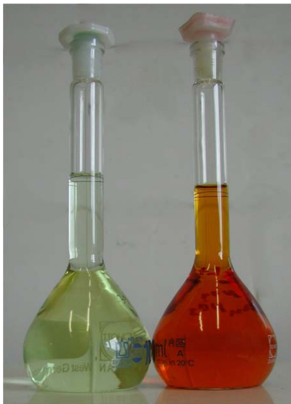
Abb. 5.51: Neuer und gealterter Platinelektrolyt
