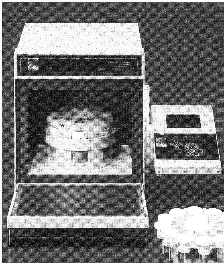
Abb. 14: Mikrowelle für den Druckaufschluß mit Rondell und Teflonautoklaven
