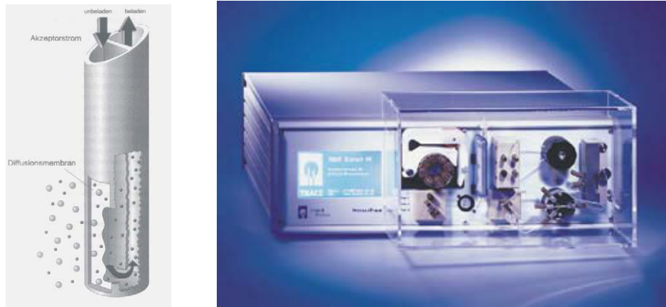
Abb. 4.1: Links: Abbildung der Dialysesonde der Process Trace-Technik. Rechts: Abbildung des on-line Analysesystems Process Trace (Quelle: Trace GmbH).
