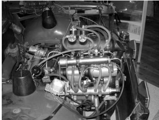
Abb. 2: \text{H}_2\text{O}_2 -Turbine in einem Wartburg; 1979 von Dr. Glaubrecht in Torgau entwickelt, 120 PS bei 16.000 U/min; ausgestellt im Fahrzeugmuseum Chemnitz-Klaffenbach
