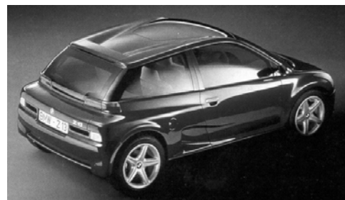
Abb. 1: BMW Z13. Versuch zur Darstellung eines „Personal Car“. Ein dreisitziges Fahrzeug mit Heckmotor, optimalem Komfort und Sicherheit für den Fahrer und stadt-adäquat-überlegenen Fahrleistungen, 1992
