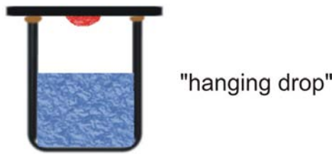
Abb. 2.3: Schematischer Aufbau der „Micro-Drop“-Analyse. 2 µl des jeweiligen Puffers mit 1 µl gereinigtem Protein (6 mg/ml) wurden auf ein Deckglas gegeben. Das Deckglas wurde über einer Vertiefung einer Multiwellplatte mit Silikon fixiert. So entsteht ein „ hanging drop “. Im unteren Reservoir befindet sich der zu testende Puffer.
