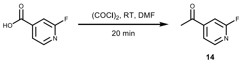
Schema 6: Synthese der von 2-Fluorisonicotinsäurechlorid 14 .
