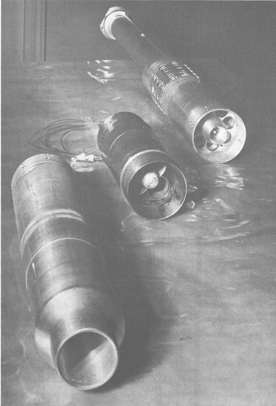
Abb.2: Zerlegte Brennelementattrappe (Turbinenelement) mit Turbinendurchflußzähler
