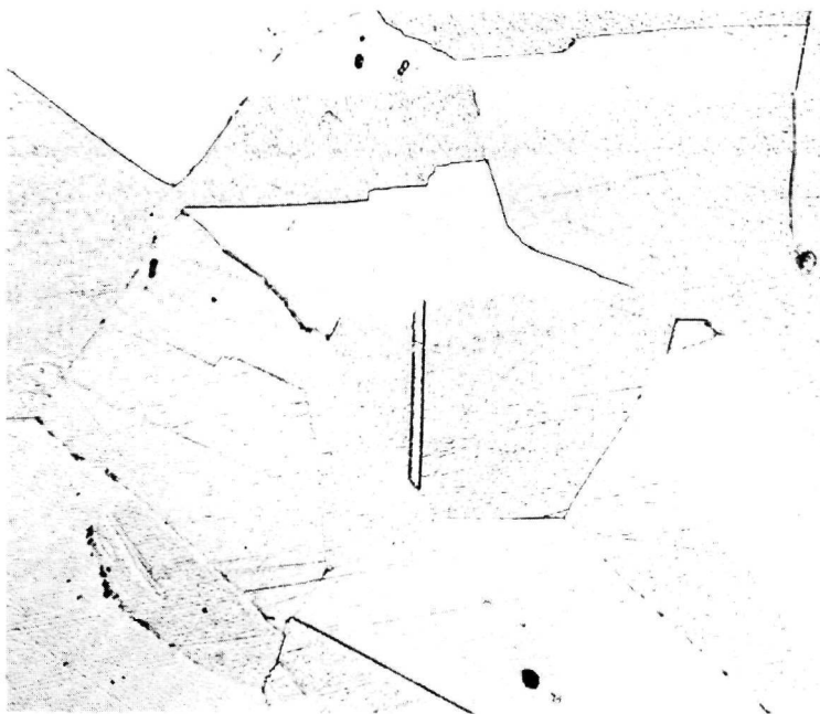
Abb. 9: Oberfläche der Werkstoffprobe 1.4306 (poliert) Nach dem Einsatz (3500 h, 200°C) mit V2A Beize geätzt (x 500)
