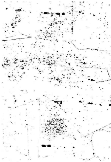
b) Oberfläche poliert, nach dem Einsatz mit V2A-Beize geätzt (x 500)
