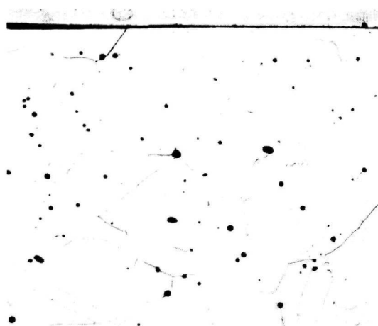
a) Oberfläche poliert 1000 h in Rb bei 500°C
