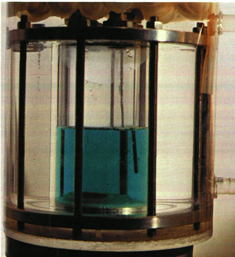
Abb. 14: Kr/Xe-Hydrat im Gleichgewichtszu- stand \Theta = 20^{\circ}\text{C} p = 13,4 \text{ bar}
