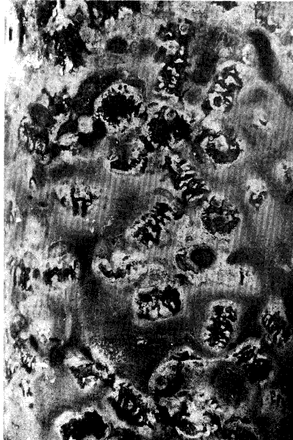
Abb. 47: Festbett-Umlauf-Reaktor mit porösem Sinterglas als Trägermaterial nach 6-monatigem Betrieb
