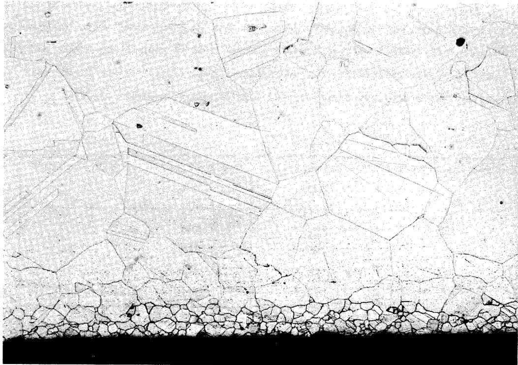
Abb. 4.1: Längsschliff von der Innenseite der Wandung eines Wt-Rohres
