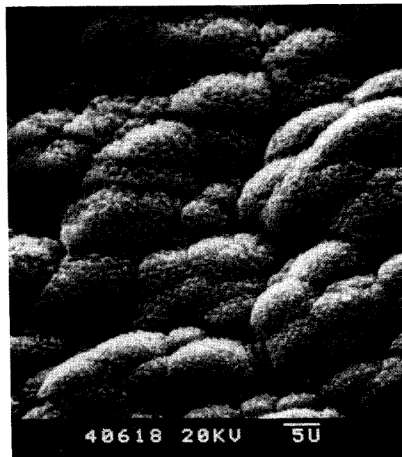
Abb. 35: Redeponierter Kohlenstoff, der sich waehrend der Belastungsexperimente an Kohlenstoffproben auf einer Sondenoberflaechen in direkter Naehe der belasteten Proben angesammelt hat. REM-Aufnahme
