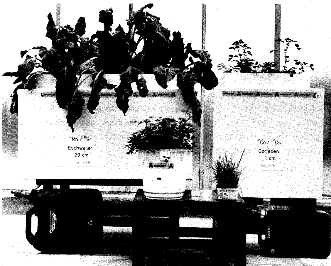
Abb. 2: Lysimeter, Kick-Brauckmann-Gefäße und Kleingefäße
