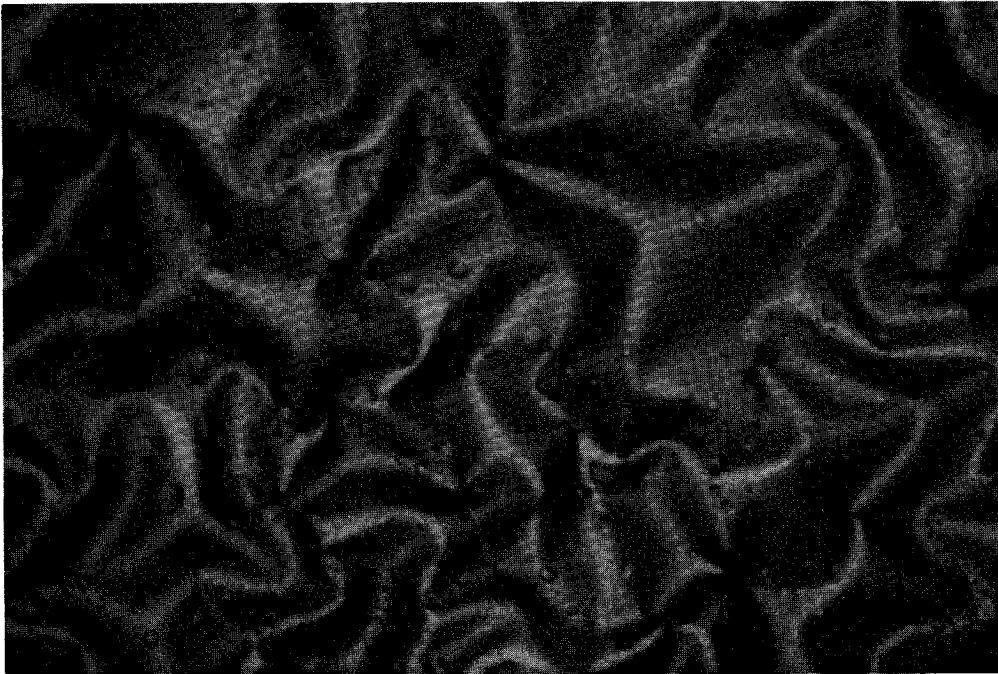
Abb. 3-5 Vom Substrat (Edelstahl) abgelöste a-C:H-Schicht (Dicke ca. 130 nm). Trotz starker Faltenbildung bleibt die Schicht noch zusammenhängend. (Gesamtvergrößerung ca. 250-fach).
