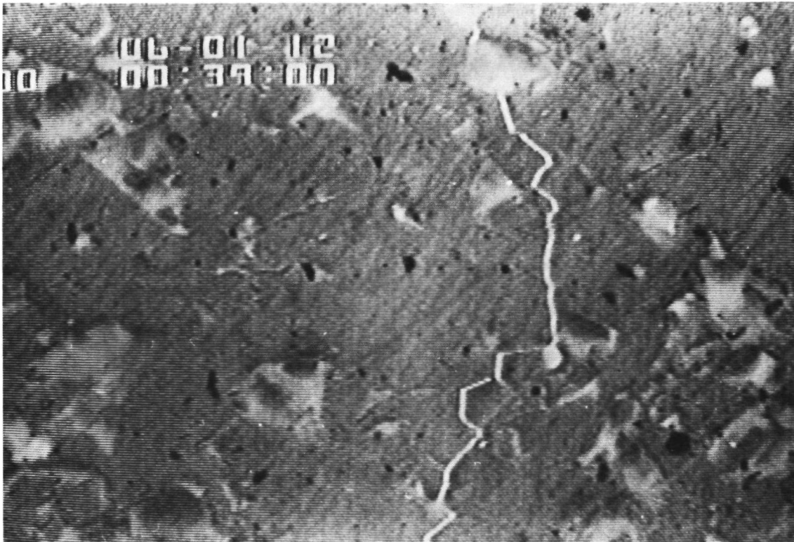
Abb. 5.24: Darstellung eines Rißverlaufs in den Rißflanken 0,5 mm hinter der aktuellen Rißspitze
