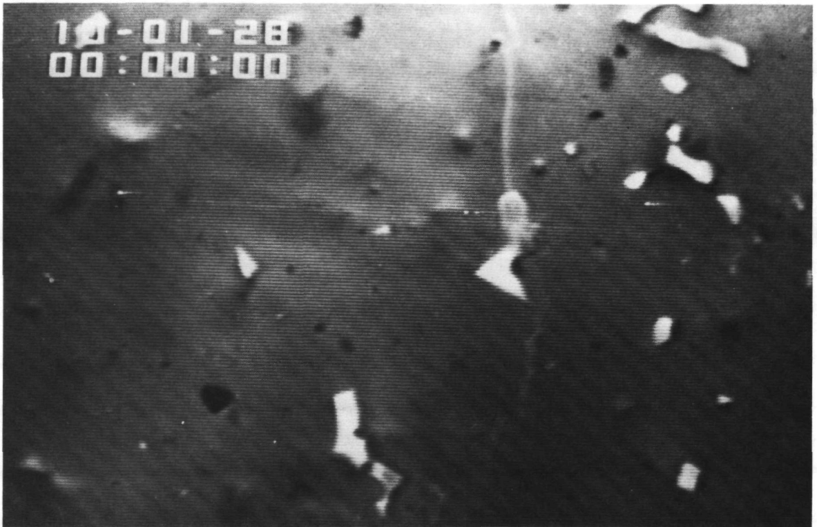
Abb. 5.20: Aufnahme des Rißfortschrittsinkrements im Rißspitzenbereich aus Abb. 5.19
