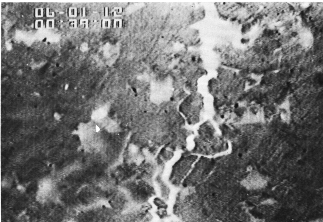
Abb. 5.30: Darstellung eines Rißverlaufs in den Rißflanken 3 mm hinter der aktuellen Rißspitze
