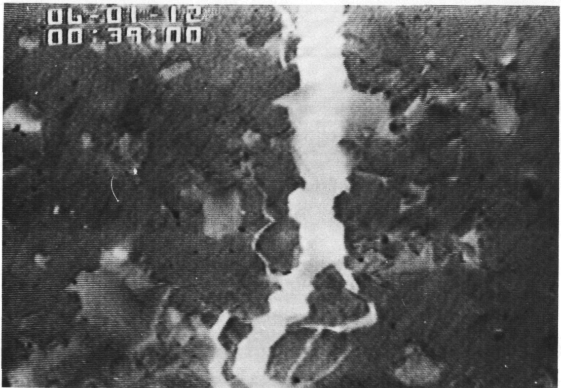
Abb. 5.32: Darstellung des Rißverlaufs aus Abb. 5.30 nach weiterer Rißverlängerung (5 mm hinter der aktuellen Rißspitze)
