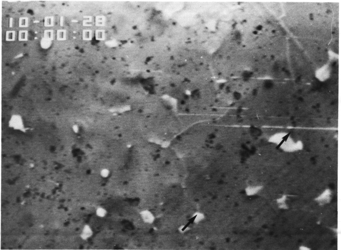
Abb. 5.22: Aufnahme des Rißspitzenbereichs während eines Rißfortschritts- inkrements (Stadium II)
