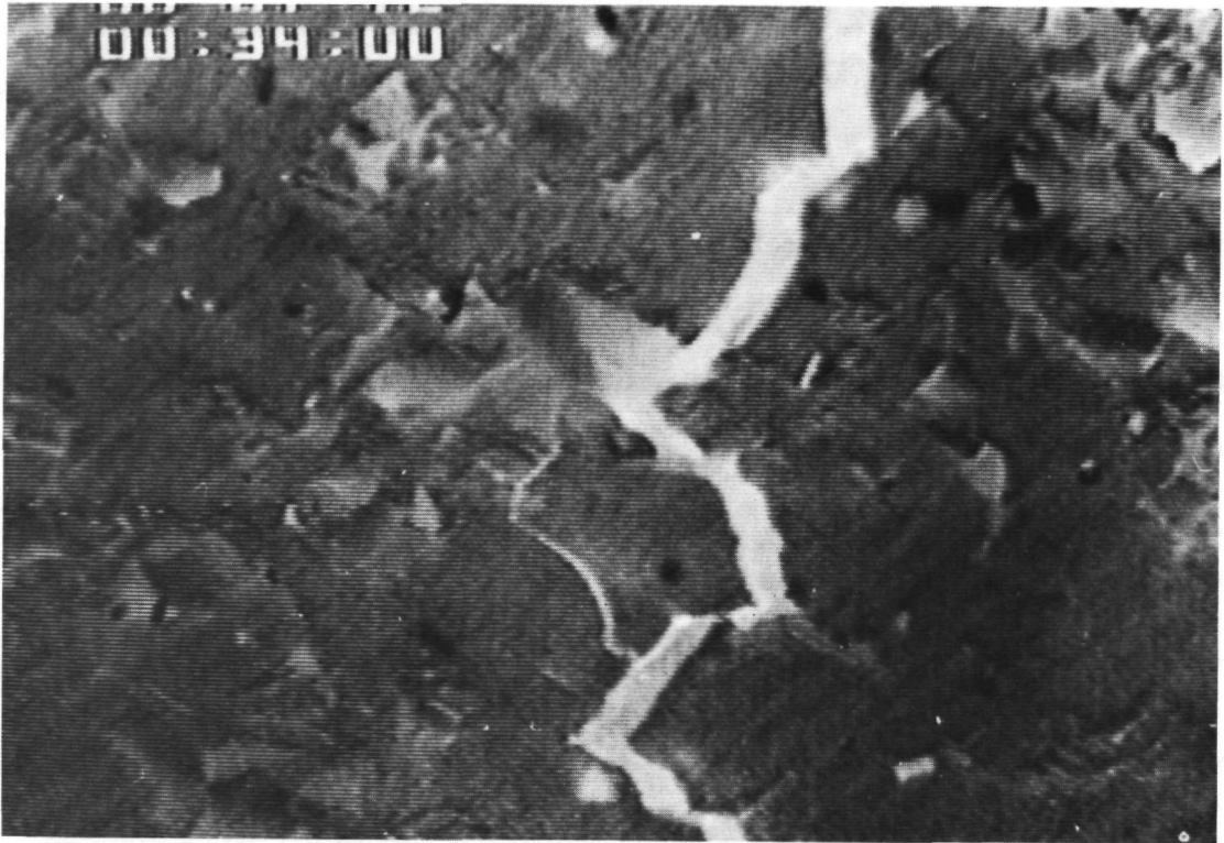
Abb. 5.28: Darstellung des Rißverlaufs aus Abb. 5.27 nach weiterer Rißverlängerung (3 mm hinter der aktuellen Rißspitze)
