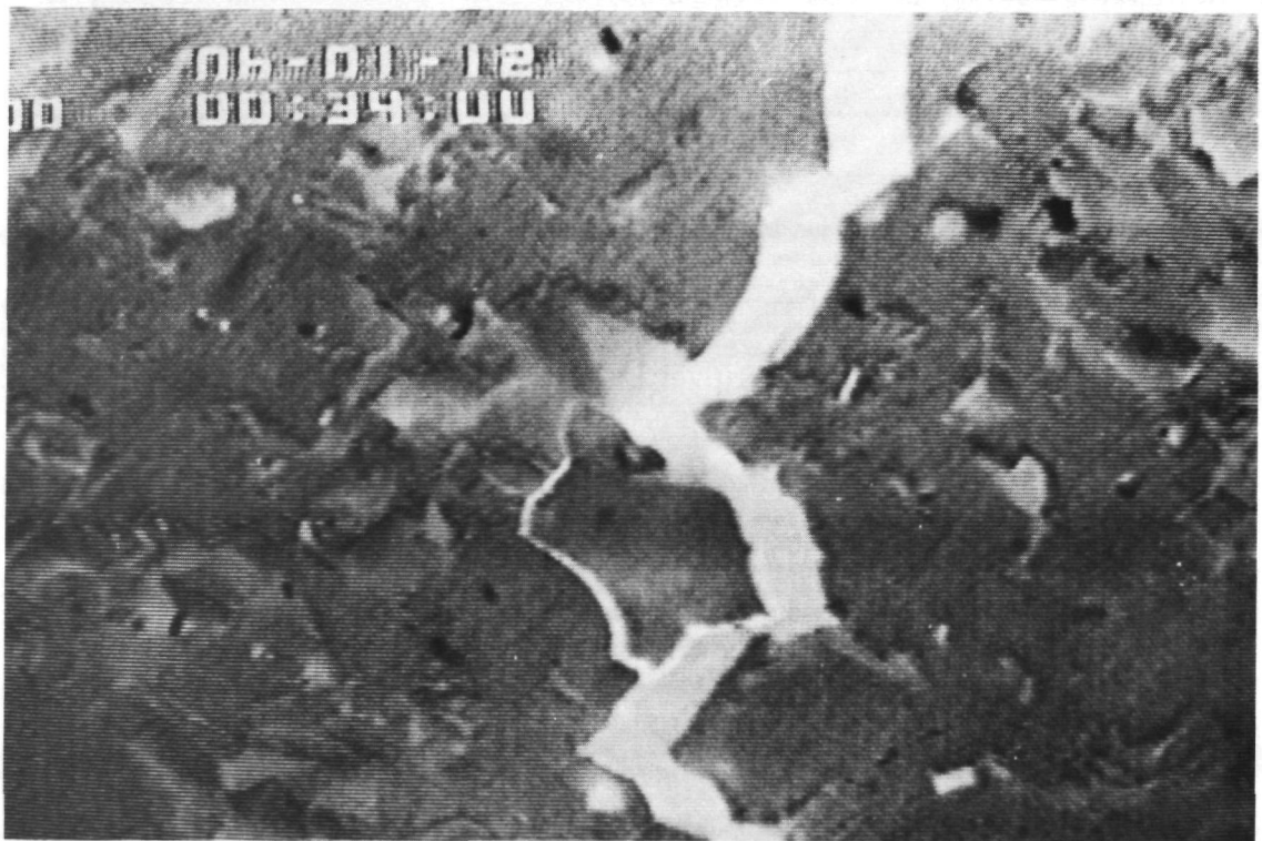
Abb. 5.29: Darstellung des Rißverlaufs aus Abb. 5.27 nach weiterer Rißverlängerung (4 mm hinter der aktuellen Rißspitze)
