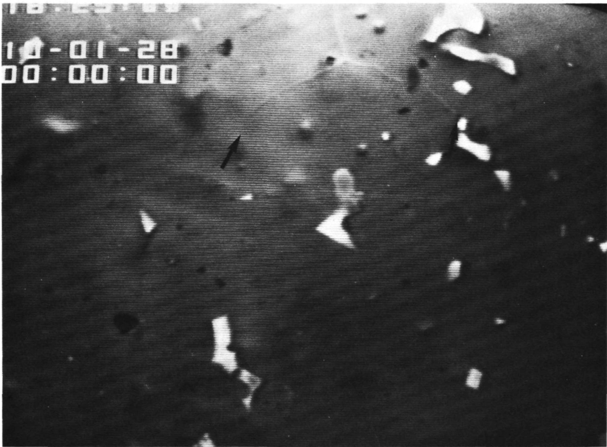
Abb. 5.19: Lokaler Rißspitzenbereich bei Rißausbreitung
