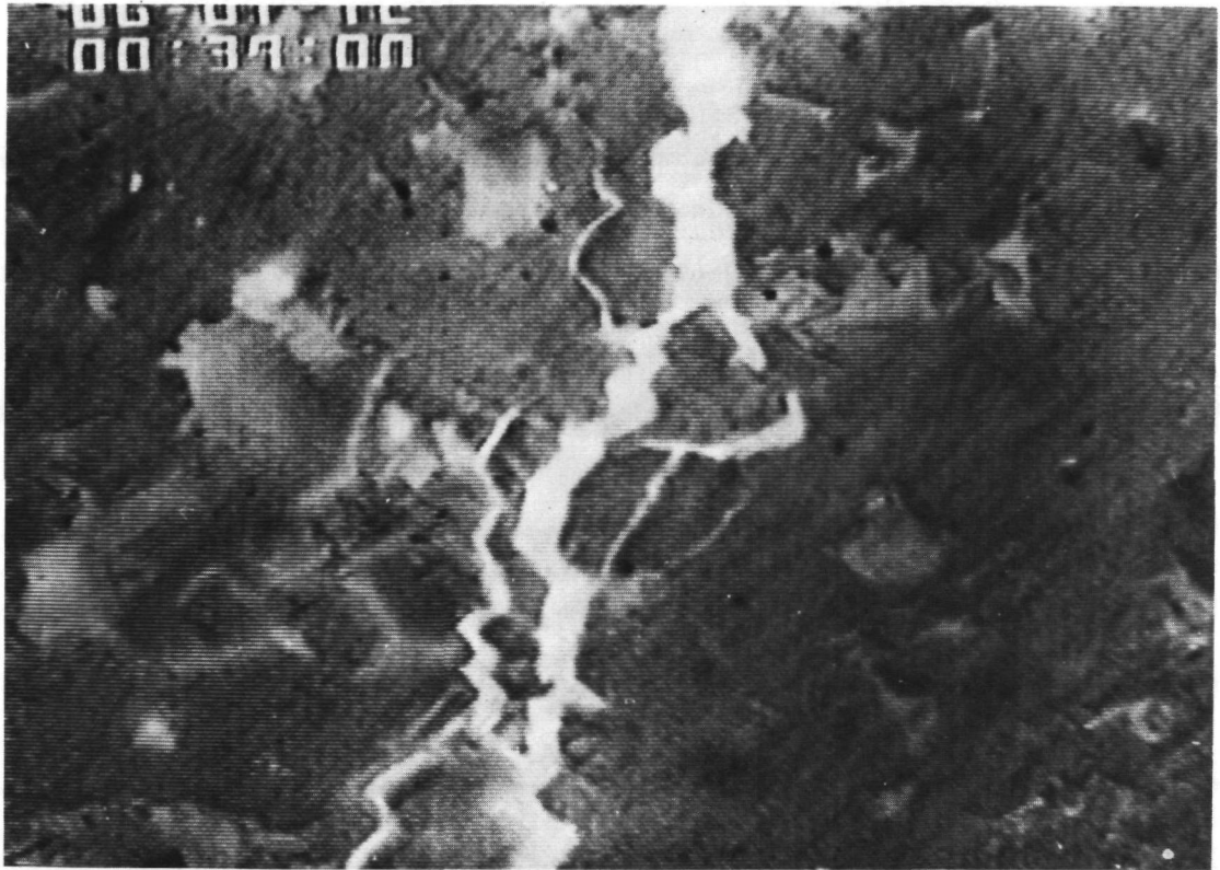
Abb. 5.31: Darstellung des Rißverlaufs aus Abb. 5.30 nach weiterer Rißverlängerung (4 mm hinter der aktuellen Rißspitze)
