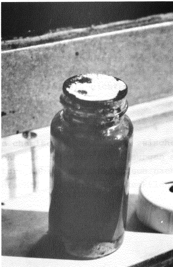
Abb. 5: Die gleiche Probe wie Bild 4. Deutlich ist die \text{I}_2 -getränkte, einseitig mit Al-be-schichtete Dichtkappe des Verschlusses zu sehen.
