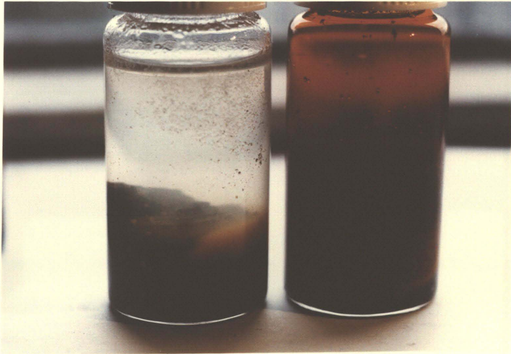
Abb. 41: Proben nach 24 Std. Nun auch in der linken Probe deutlich sichtbar die \text{Fe}(\text{OH})_3 - und Ag-Schlamm-bildung
