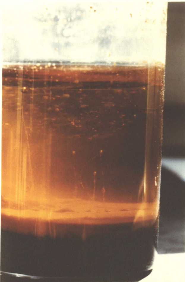
Abb. 31: Die Probe mit Zement nach 48 Stunden. Sichtbar die Gasentwicklung und die \text{Fe}(\text{OH})_2 -Schicht.
