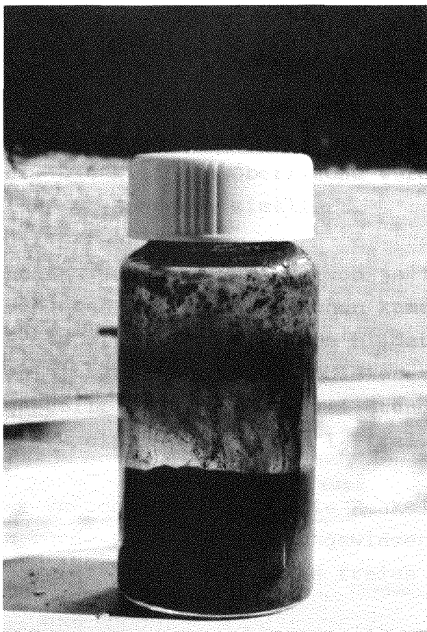
Abb. 3: Deutlich sieht man den vom H_2 hochgerissenen Ag-Schlamm und das sublimierte Jod an den Glaswandungen
