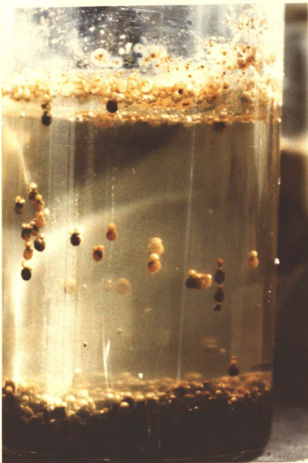
Abb. 14: Probe nach 18 Stunden Grünfärbung der Lösung, Schweben der Filterpartikel und Jodsublimation
