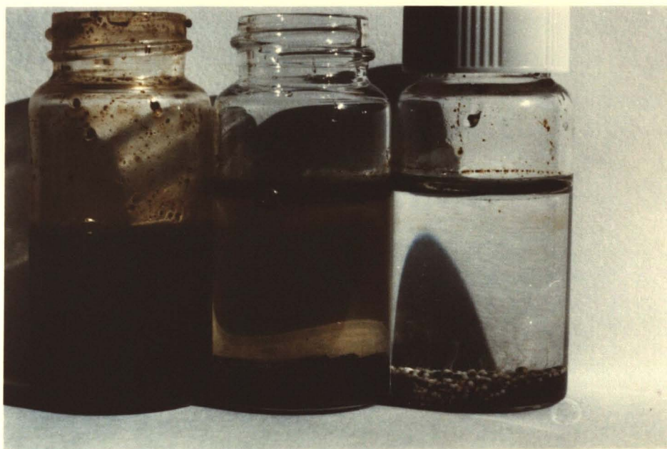
Abb. 15: Aussehen der Proben nach drei verschiedenen Standzeiten. Links: Nach sechs Wochen Mitte: Nach zwei Wochen Rechts: Nach 30 Minuten
