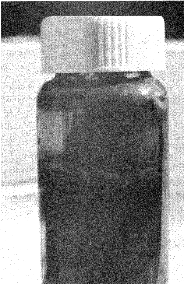
Abb. 4: Eisenschraube in der Salzlösung in Gegenwart von \text{AgI}/\text{AgIO}_3 . Aussehen nach zwei Monaten. Deutlich sichtbar die Schicht des \text{Fe}(\text{OH})_3 .
