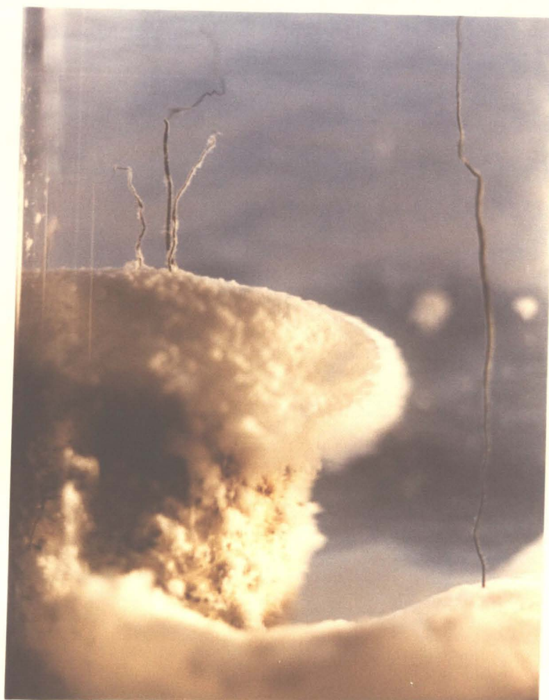
Abb. 54: Das Wachsen von \text{Fe}(\text{OH})_3 -Gebilden auf dem Probenblock
