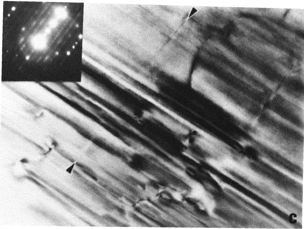
Abbildung 6.3: Versetzungsanalyse einer 'Typ A'-Versetzung im Hellfeldmodus. Abb. (a) zeigt die Versetzung mit \vec{g} = [00001] in Kontrast, Abb. (b) und (c) mit \vec{g} = [10\bar{1}\bar{1}0] bzw. \vec{g} = [01\bar{2}20] (bis auf einen unwesentlichen Restkontrast) ausgelöscht. Die Abbildungsbedingungen sind durch die gezeigten Beugungsbilder dokumentiert. Die Blickrichtung ist etwa entlang einer [1\bar{2}100] -, [001\bar{1}0] - bzw. [1\bar{2}100] -Achse in (a), (b) bzw. (c).
