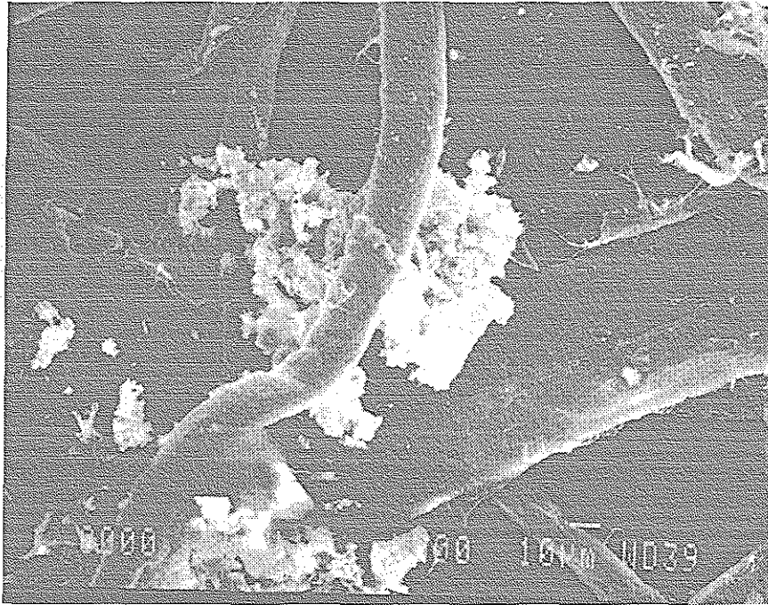
Bild 4: Rasterelektronenmikroskopische Aufnahme des roten, feinen Selen in Filterfasern
