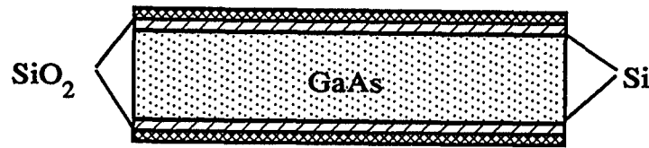
Bild 6-1: schematische Darstellung einer mit Silizium bedampften und mit \text{SiO}_2 -gekapselten GaAs-Probe
