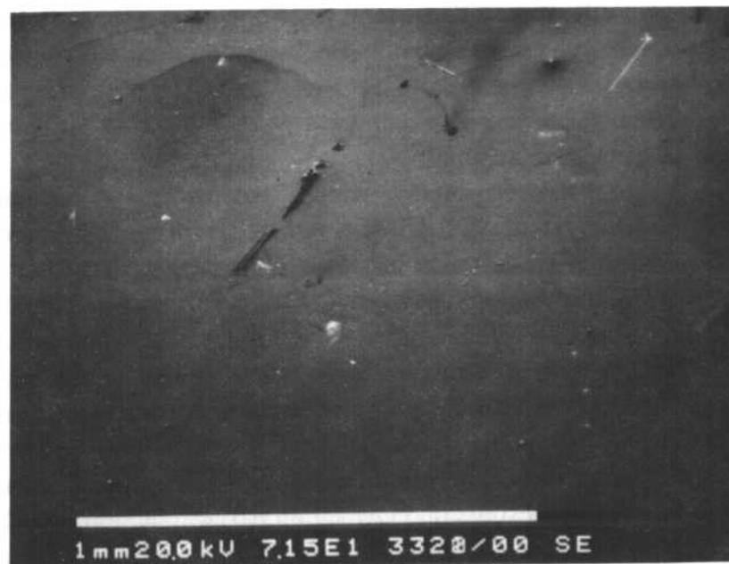
Bild 6-3: REM-Aufnahme einer GaAs-Probe, die mit Silizium bedampft und bei 900 °C für 100 Stunden getempert wurde
