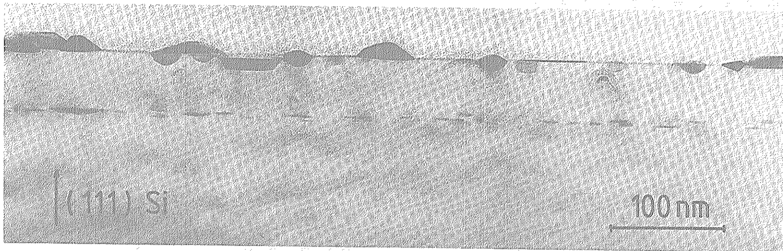
Abb. 7.14: TEM-Querschnittsaufnahme einer mit \text{FeSi}_2 -Clustern bedeckten Probe. Die Substrattemperatur beim Aufdampfen betrug 700^\circ\text{C} .
