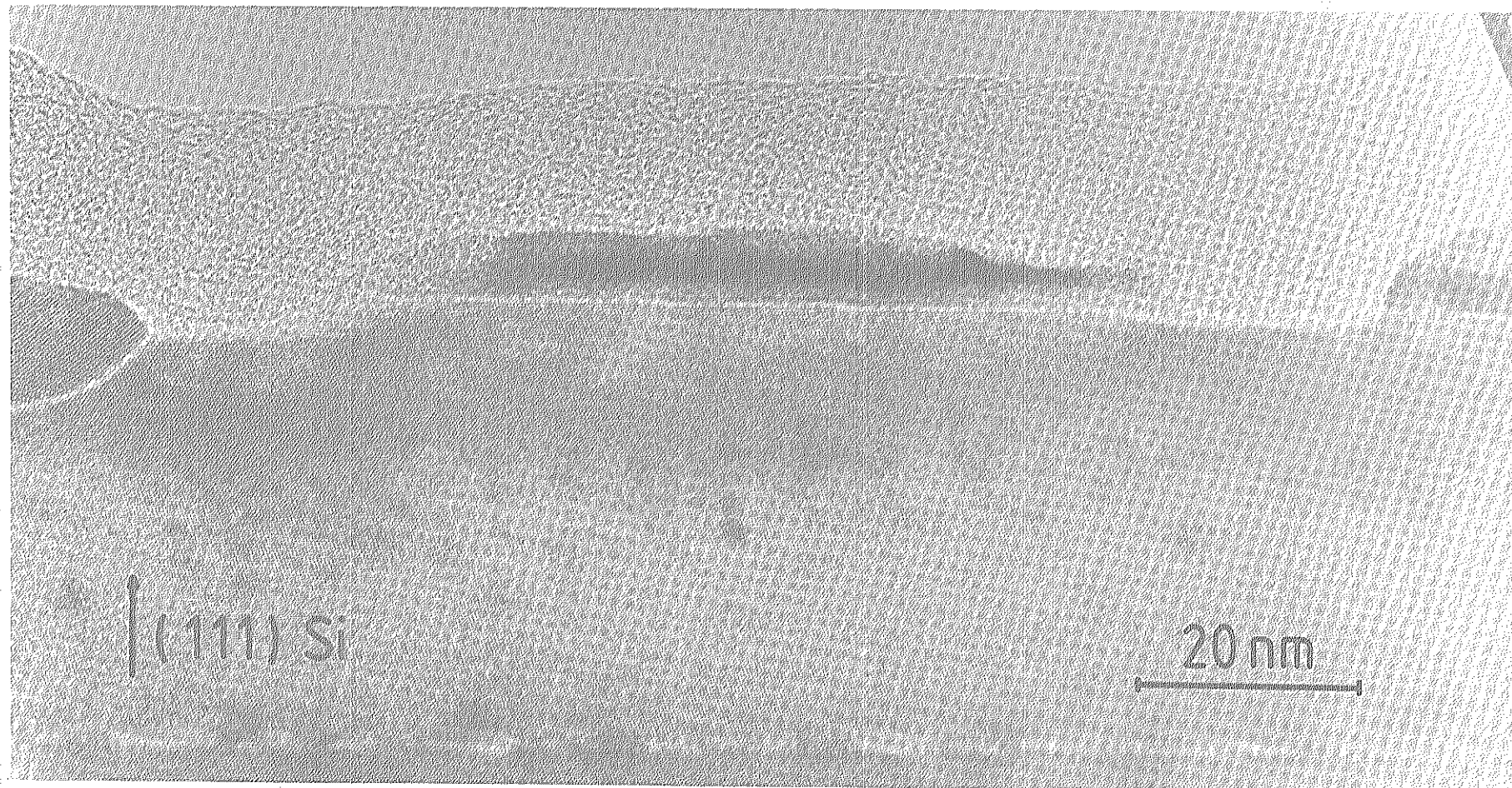
Abb. 7.23: Hochaufgelöste TEM-Querschnittsaufnahme einer mit \text{FeSi}_2 -Clustern bedeckten Probe. Die Substrattemperatur beim Aufdampfen betrug 660^\circ\text{C} .
