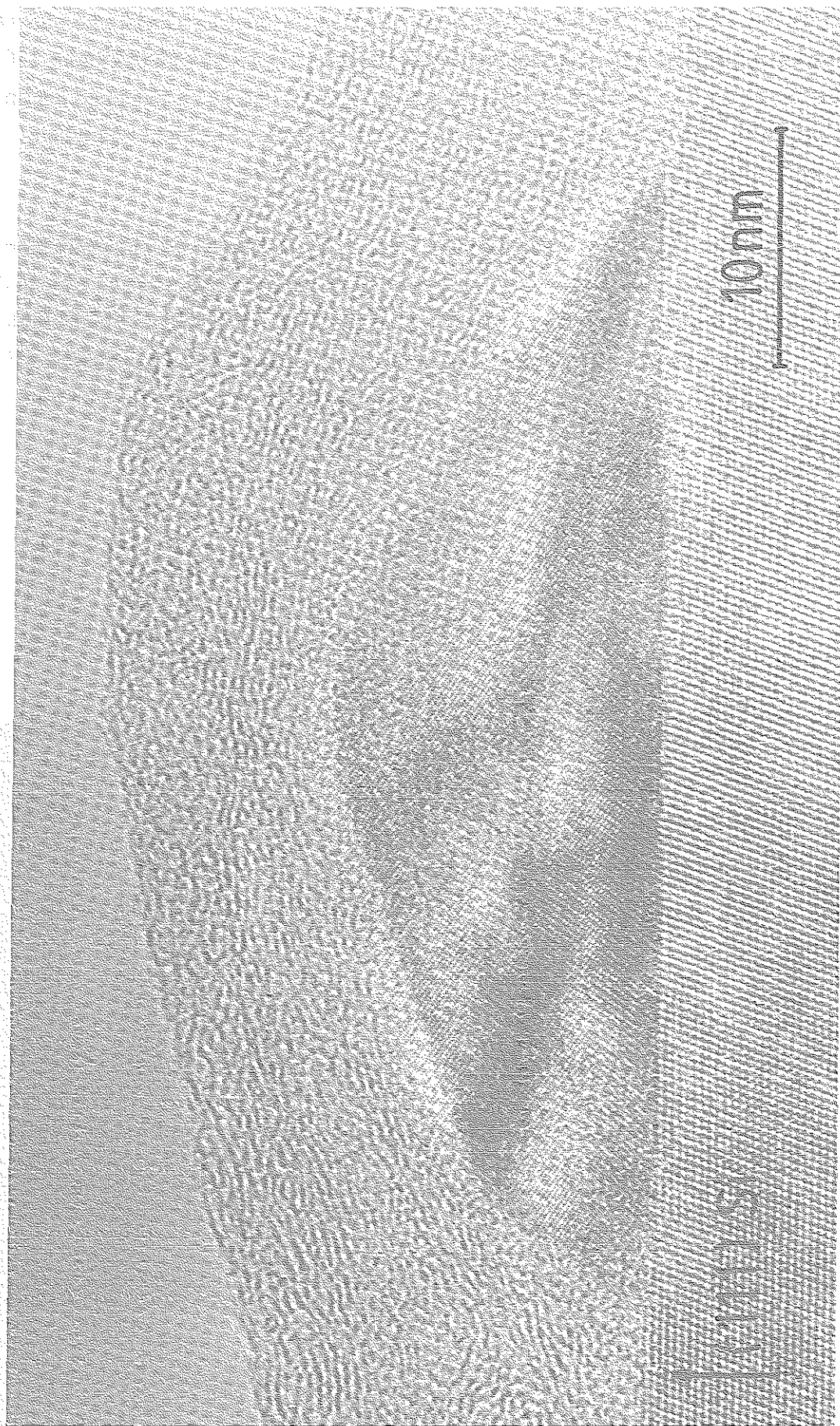
Abb. 7.17: Typischer \alpha -FeSi 2 -Cluster auf einer Si(111)-Oberfläche. Die Substrattemperatur während des Aufdampfens betrug 700°C.
