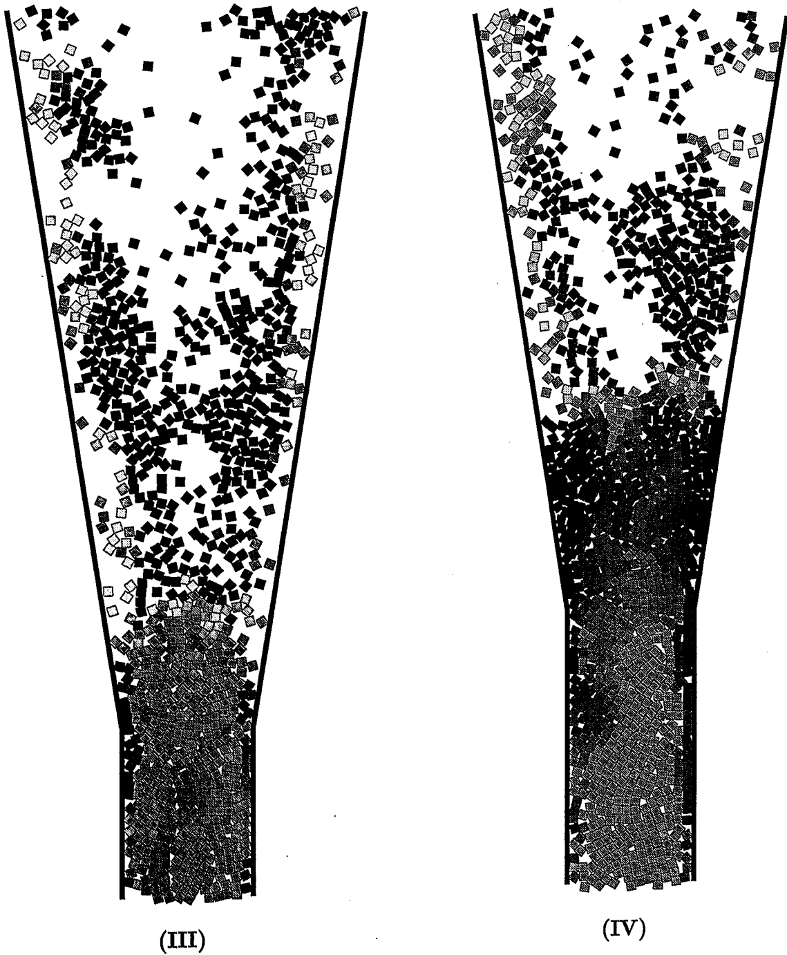
Abbildung 6.11: Die Graustufen repräsentieren die kinetische Energie der Teilchen, d. h. Translations- plus Rotationsenergie. Helle Töne entsprechen einer kleinen, dunkle Töne einer großen kinetischen Energie.
