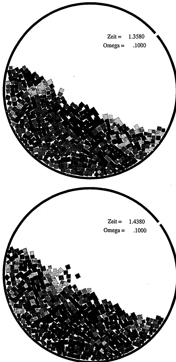
Abbildung 7.4: Vier Zeitschritte der Entstehung einer Lawine. Die Graustufen stellen die Geschwindigkeiten der Teilchen dar. Die Rotationsfrequenz der Trommel beträgt 0.1 \text{ s}^{-1} . Die Zeiten sind in den Grafiken angegeben.
