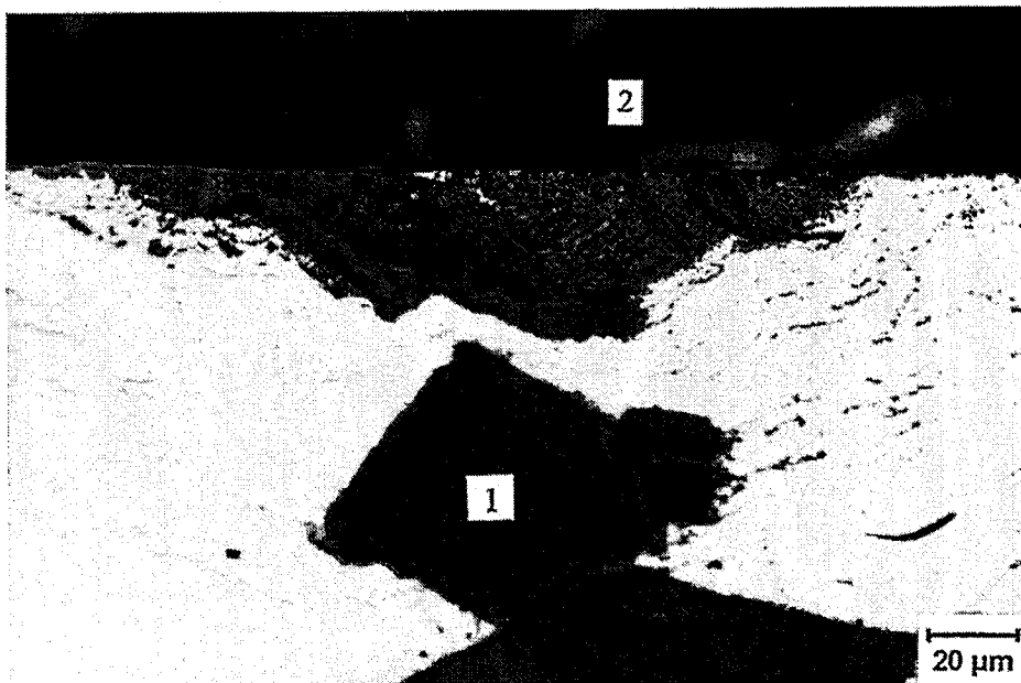
Abb. 6.60: Vereinzelte Erscheinungsweise der Reibschicht bzw. bremsflächennaher Bereiche eines Cu-Basis-Belages
