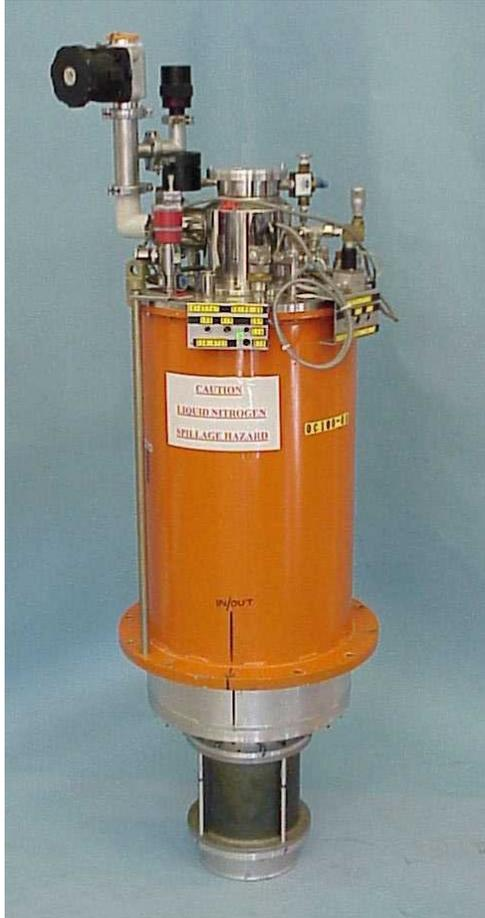
Orange Kryostat aus Münchner Bestand, der aufgearbeitet und an den MAGIC Probenort angepasst wird
