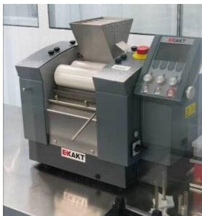
Abb. 15: Dreiwalzwerk zur Homogenisierung von Siebdruckpasten.
