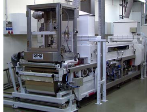
Abb. 13: Foliengießbank für große Schlickeranordnungen mit einer Gießbreite von bis zu 50 cm.
