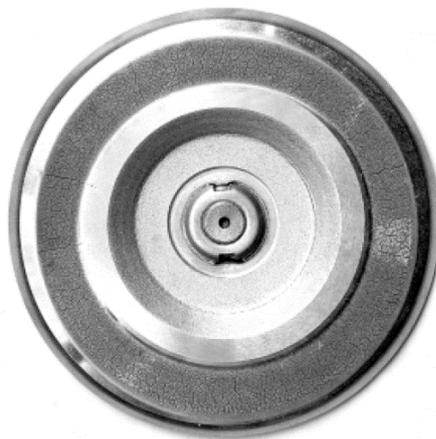
**Abbildung 2.6.:** Rissbild einer Anode aufgrund thermischer Spannungen [2].
