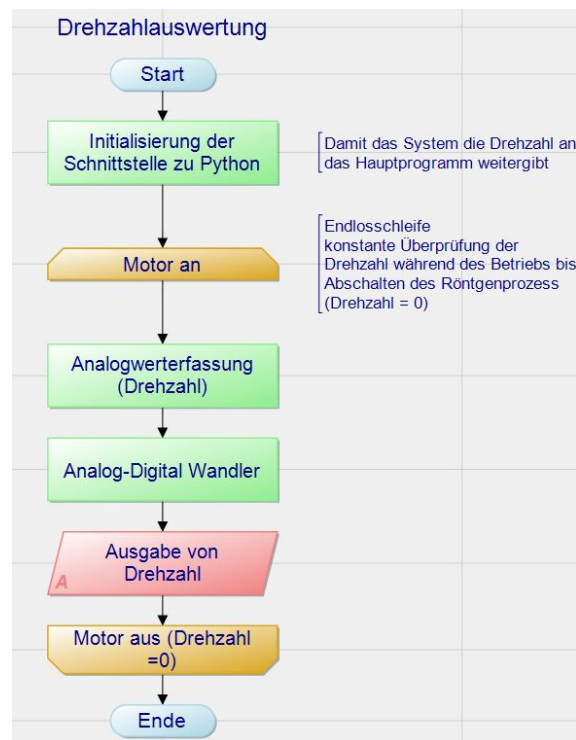
Abbildung 3.6 Programmablaufplan der Drehzahlabfrage
