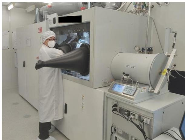
Abbildung 6: MOCVD (Metall-organische chemische Gasabscheidung) Anlage wurde als „JULE: Juelich advanced tool for 2D-Layer-Epitaxy“ in Betrieb genommen.
