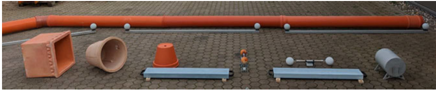
Abb. 8: Geplante Anordnung des Testmessobjekte auf dem Meeresboden: Tongefäße, Ebenheitsnormale, Kugelstäbe, Zylinder (v.l.n.r.). Eine Bombenattrappe (fehlt im Bild) wurde noch neben den Zylinder platziert. Im Hintergrund ein Teil des „Rohrleitungssystems“
