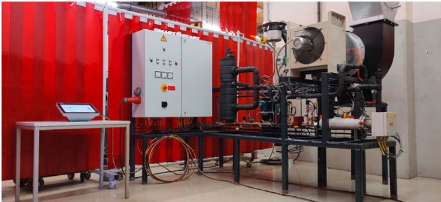
Abb. 11: Versuchsaufbau mit repräsentativen Automationssignalen, im Labor der Meyer Werft
