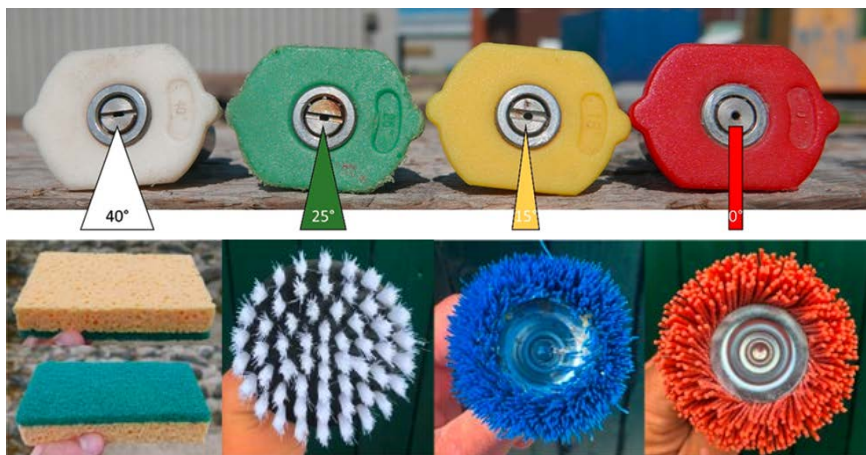
Abb. 2: Reinigungsutensilien im Projekt »ROBUST«: Oben sind die Aufsätze für den Hochdruckwasserstrahl zu sehen, die sich durch einen anderen Strahlwinkel auszeichnen. Die untere Fotofolge zeigt die schwamm- bzw. bürstenbasierten Reinigungsinstrumente, beginnend mit dem Schwamm (weiche und harter Seite), Bürstenköpfe weich (weiß), mittelhart (blau) und hart (rot). Bei der ersten Inspektion der Verschleißproben kamen nur der Schwamm und die weiche Bürste zum Einsatz. © Brill + Partner GmbH
