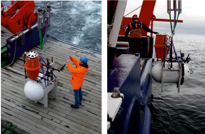
Abb. 11: Letzte Vorbereitungen und Aussetzen des DeepC3000 im Lander; Bilder: T. Soltwedel, AWI)
