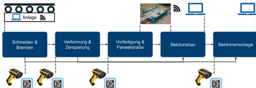
Abb. 5: Hardware-Installationen für Track-and-Trace im definierten Soll-Prozess in der Sektionsfertigung
