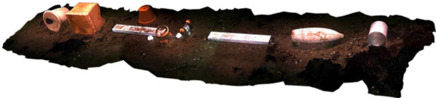
Abb. 9: Tatsächlich realisierte Anordnung auf dem Meeresboden (Bild erzeugt aus 3D-Rekonstruktion mittels visueller Odometrie): die Bombenattrappe wurde zwischen Zylinder und ein Ebenheitsnormal platziert
