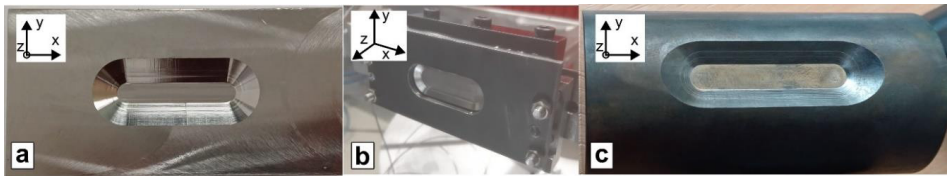
Abbildung 3-3: In Anlehnung an den Reparaturprozess herausgearbeitete Kavität (a). Zur Vermeidung von Materialüberschuss erfolgte eine zusätzliche Maskierung der Fläche um die Kavität (b). Alternativ erfolgten Beschichtungen von zylindrischen Kavitäten (c). Alle Richtungsangaben in dieser Arbeit beziehen sich auf das beigefügte Koordinatensystem.
