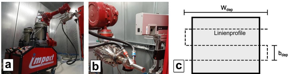
Abbildung 3-1: Aufnahmen der verwendeten Kaltgassanlage (a) sowie der Düse mit vorgeschaltetem Heizelement (b). Der Beschichtungsmäander setzt sich aus der horizontalen Bewegung mit definierter Länge ( W_{dep} ) sowie Versatz in vertikaler Richtung ( b_{dep} ) zusammen (c).
