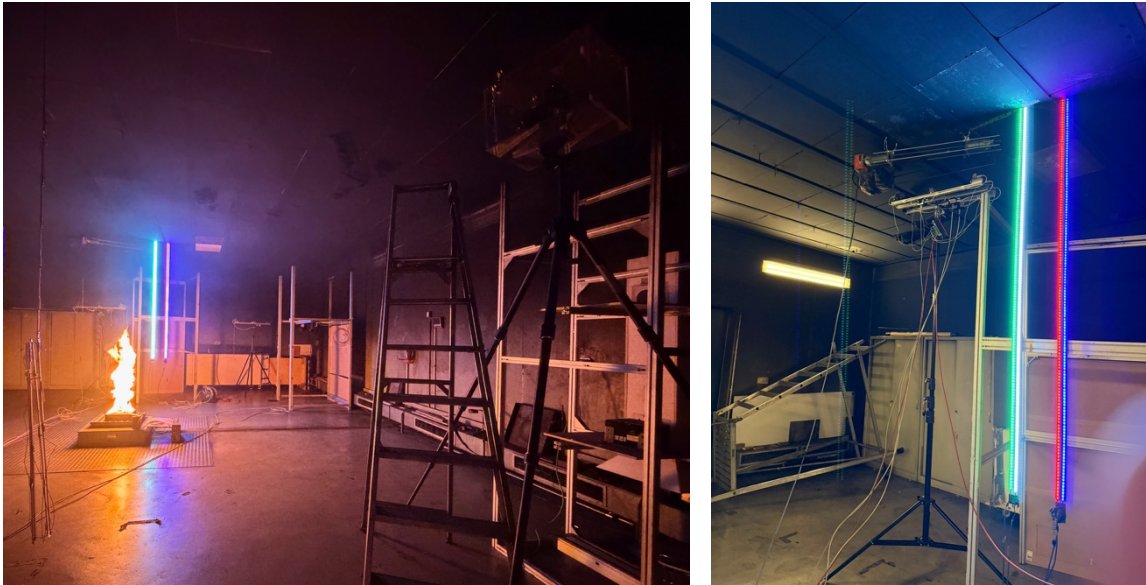
Abbildung 2: Versuchsraum bei einem Heptan-Brand. Links: Übersicht beim Brandversuch mit einer Kamera für die LEDSA-Messungen in der rechten Ecke. Rechts: Positionen der Messgeräte, hier u.a. MIREX, LEDSA-Streifen und ELPI+ (Einsaugung durch die Decke, das Messgerät ist über der Decke).
