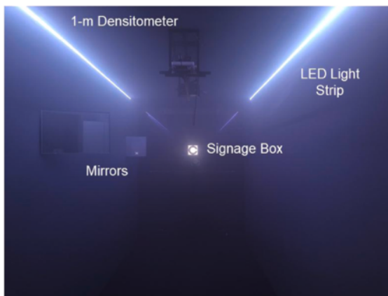
Abbildung 7: (a) Neuer experimenteller Versuchsaufbau zur Untersuchung der Sichtbarkeit von Beschilderun. (b) Vorderansicht der Kammer und (c) Rückansicht der Kammer. Aus [7].
