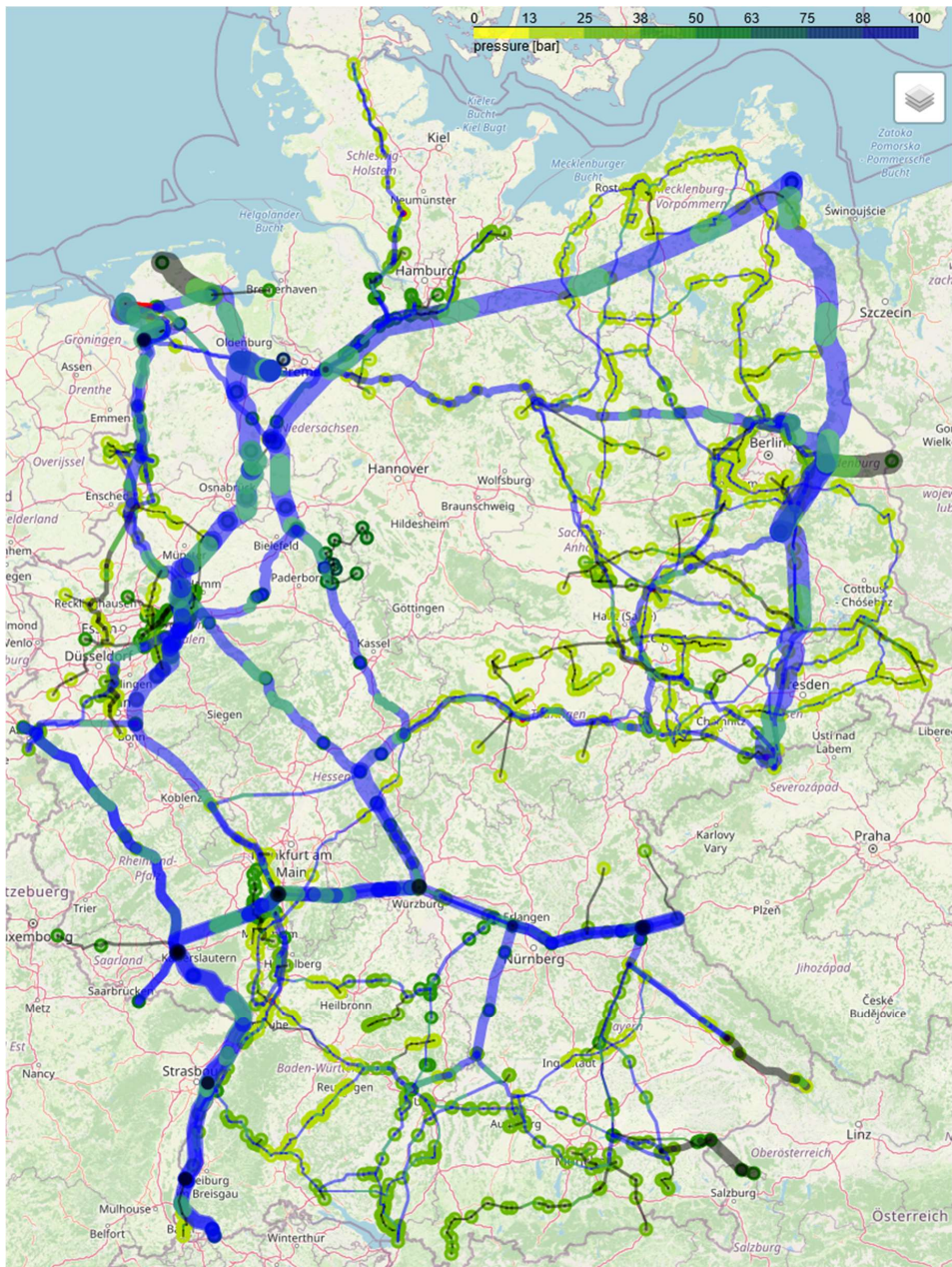
Abbildung I.8.18.17: Flüsse und Drücke in der Erdgas-Nominierung des 02.12.2015 um 05:00 Uhr. Die Drücke an den Knoten sind entsprechend des dargestellten Farbcodes (oben rechts) eingefärbt. Die Dicke der Kanten ist proportional zum Fluss darüber. Legende, siehe Tabelle I.8.1.1.
