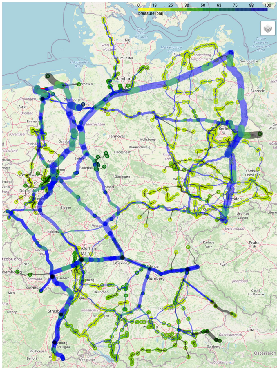
Abbildung 5.2.3.4: Flüsse und Drücke in der Erdgas-Nominierung des 02.12.2015 um 05:00 Uhr. Die Drücke an den Knoten sind entsprechend des dargestellten Farbcodes (oben rechts) eingefärbt. Die Dicke der Kanten ist proportional zum Fluss darüber.
