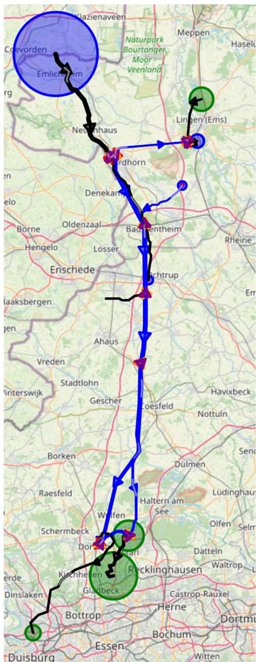
Abbildung I.8.4.2: Flüsse im 2025 Basisszenario bei 60 bar Maximaldruck und angenommener Rohrrauigkeit von 1 mm. Legende, siehe Tabelle I.8.1.1.
