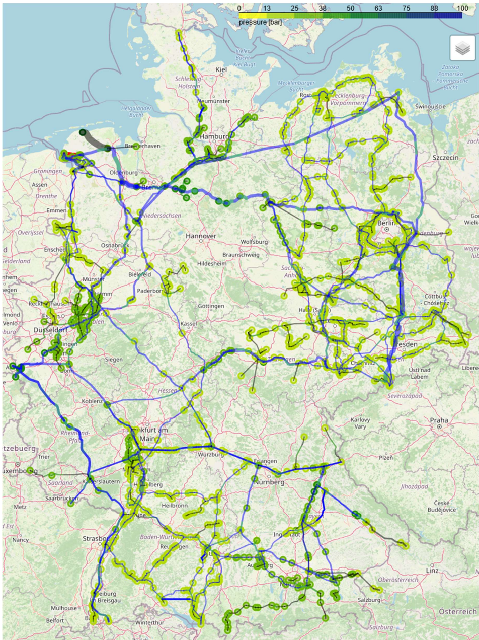
Abbildung I.8.18.9: Flüsse und Drücke in der Wasserstoff-Nominierung des 11.08.2015 um 15:00 Uhr (unlösbar, d.h. verbleibendes Node-Slack). Die Drücke an den Knoten sind entsprechend des dargestellten Farbcodes (oben rechts) eingefärbt. Die Dicke der Kanten ist proportional zum Fluss darüber. Legende, siehe Tabelle I.8.1.1.
