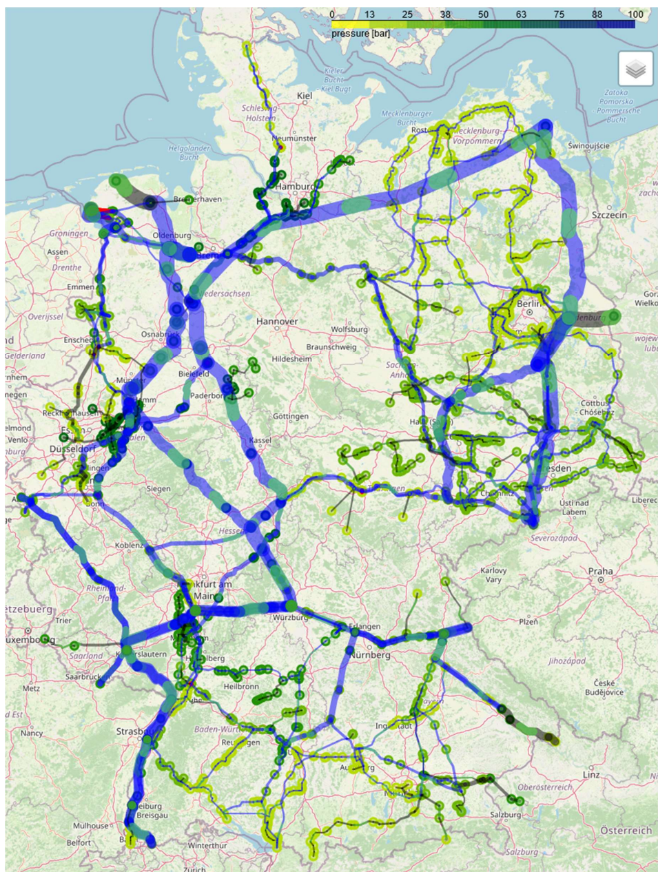
Abbildung I.8.18.14: Flüsse und Drücke in der Erdgas-Nominierung des 27.11.2015 um 17:00 Uhr. Die Drücke an den Knoten sind entsprechend des dargestellten Farbcodes (oben rechts) eingefärbt. Die Dicke der Kanten ist proportional zum Fluss darüber. Legende, siehe Tabelle I.8.1.1.
