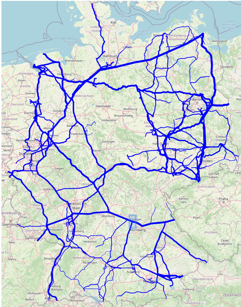
Abbildung 3.2.3.1: Überblick: Graph der repräsentierten Netztopologie des deutschen H-Gas-Netzes. Die Breite der dargestellten Kanten ist proportional zum jeweiligen Pipelinedurchmesser. Das blaue Rechteck im Raum Nürnberg-Erlangen ist als Vergrößerung in Abbildung 3.2.3.2 dargestellt.
