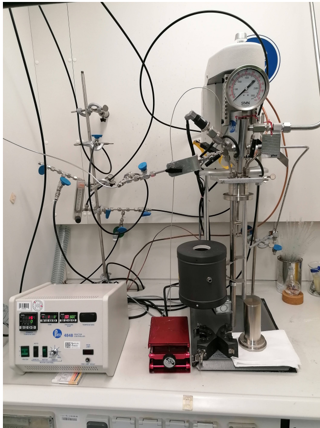
Abbildung 7.1. Aufbau des Autoklavenreaktors für experimentelle Untersuchungen der Katalysatoren. V_R = 100 \text{ mL}
