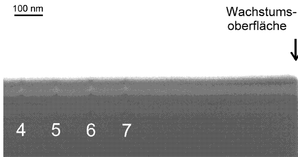
Abbildung 5.5: Übersichtsaufnahme einer typischen Probe nach Diffusionsexperiment unter antimonreichen Bedingungen. TEM-Hellfeldbild, Abbildungsbedingung: Fünfstrahlfall. Es sind vier der sieben aluminiumreichen Schichten abgebildet (Ziffern) sowie die gesamte nachfolgende GaSb-Schutzschicht. Die Dickenkonturen der GaSb-Bereiche sind bis hin zur Wachstumsoberfläche mit denen des GaSb-Substrats identisch und unterscheiden sich nicht von denen des unbehandelten Materials.
