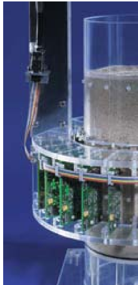
Ein Ring aus Magnetfeldsensoren liefert Informationen über Bodenstruktur, Feuchte und Transportwege für Schadstoffe aus dem Inneren des Bodens.
