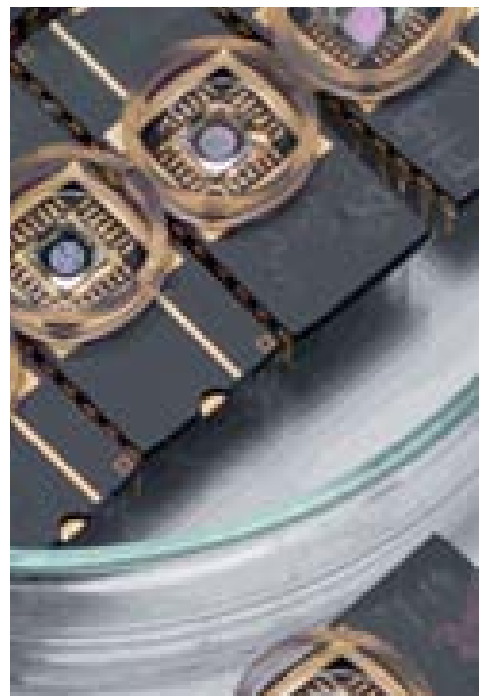
In kleinen Schalen, direkt auf die Kontakte eines Chips, bringen Forscher einzelne Nervenzellen auf und untersuchen deren Signalweiterleitung.
