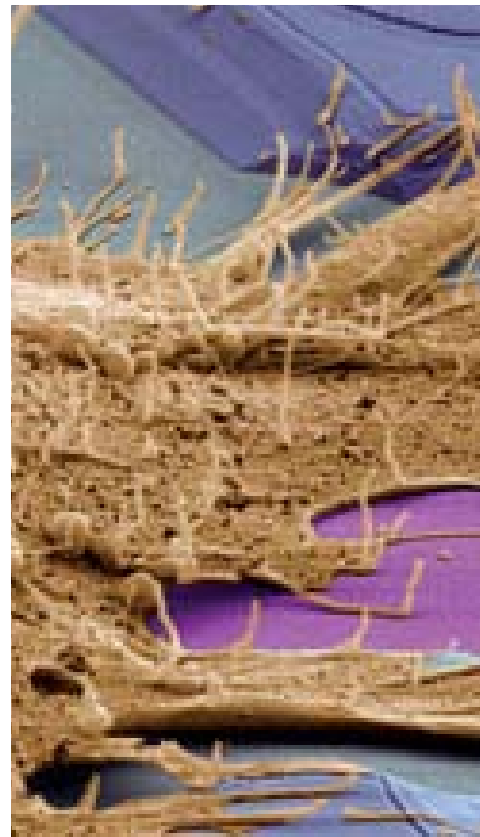
Mit der Kontaktfläche eines Transistors wird das elektrische Potenzial einer Zelle bei der Reizweiterleitung ausgemessen.
