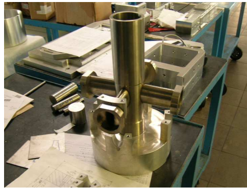
Bild 4.2: Fertigung des Drehkreuzes für die Aufnahmen der Spulen.
