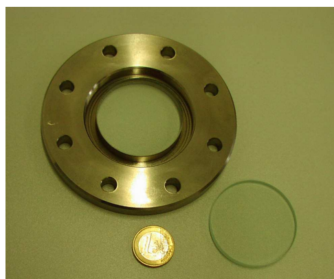
Bild 4.3: Optisches Fenster bestehend aus Titanflansch und MgF_2 -Fenster.
