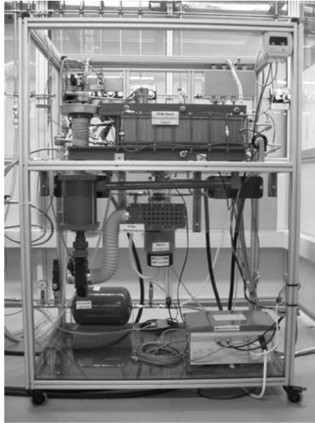
Abbildung 15.4: Brennstoffzelleneinheit des EDIson-Systems an der Universität Karlsruhe. Die elektrische Ausgangsleistung beträgt 1,8 kW.
