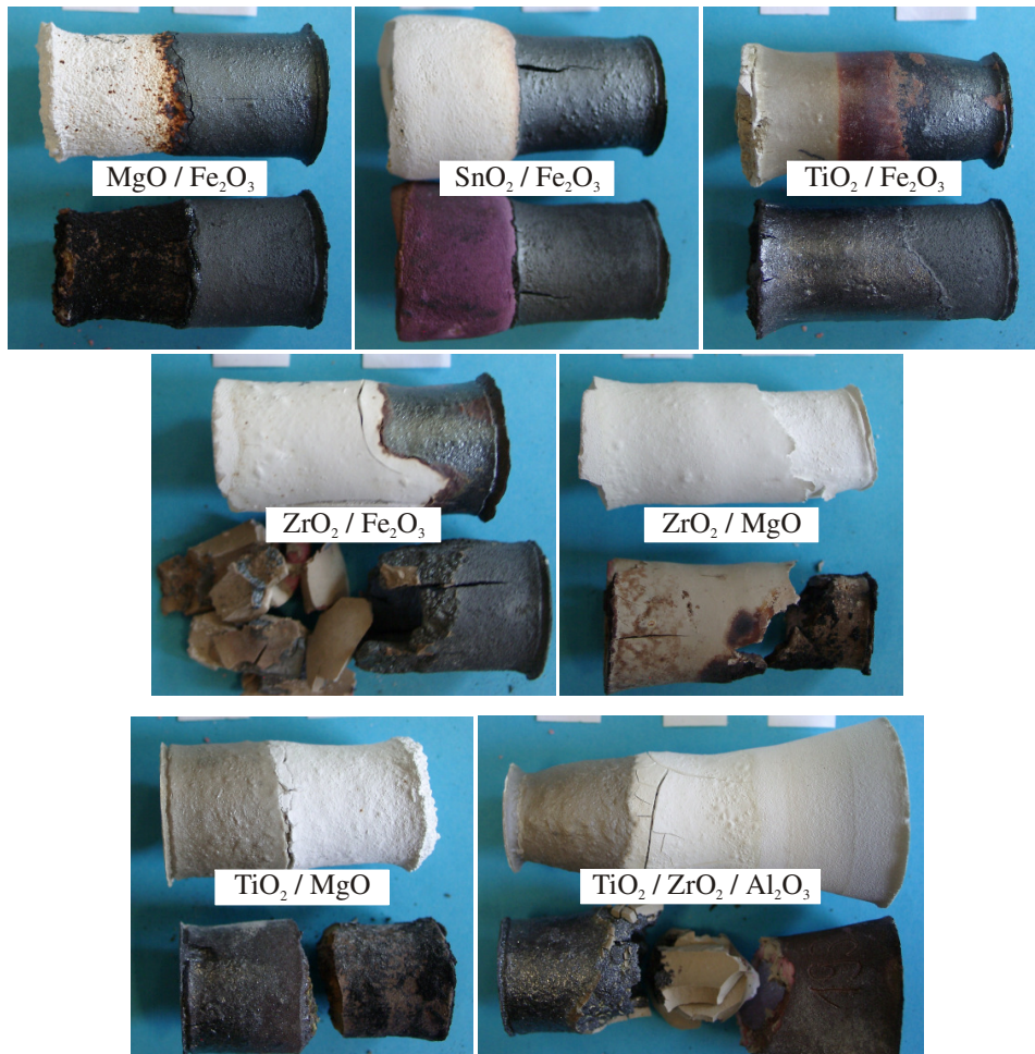
Abbildung 107: Keramikkombinationen vor (jeweils oben) und nach (jeweils unten) der Auslagerung im Feinstabscheider
