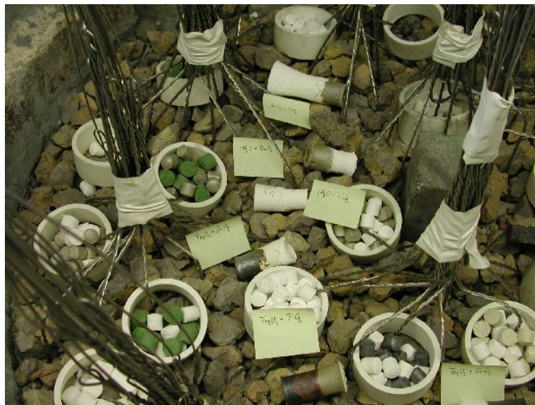
Abbildung 104: Einbausituation der Keramiken für die Feinstabscheidung
