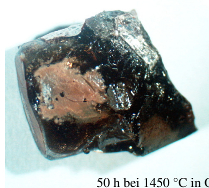
Abbildung 167: \text{MoSi}_2 -15% \text{HfO}_2 -Proben nach der Auslagerung in Schlacke
