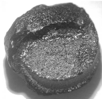
Abbildung 141: SEPR-Probe mit Schlackeeresten nach der Auslagerung in Schlacke
