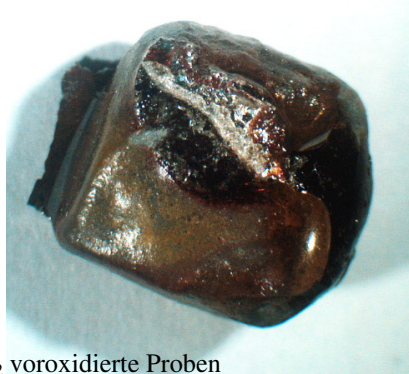
Abbildung 167: \text{MoSi}_2 -15% \text{HfO}_2 -Proben nach der Auslagerung in Schlacke
