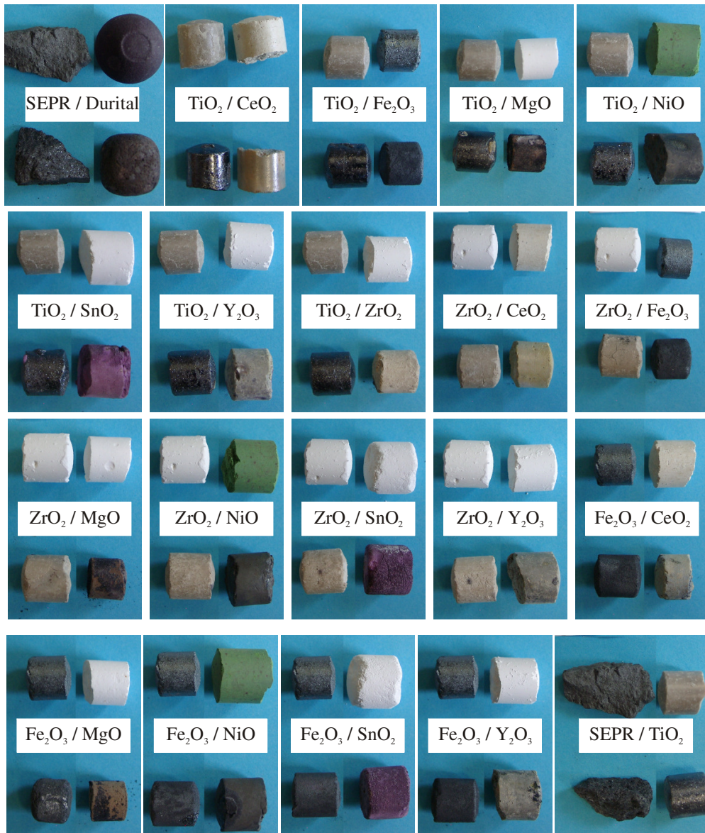
Abbildung 106: Keramiken aus ungeordneten Schüttungen vor (jeweils oben) und nach (jeweils unten) der Auslagerung im Feinstabscheider
