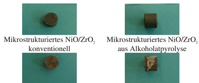
Abbildung 108: Mikrostrukturiertes NiO/ZrO 2 vor (oben) und nach (unten) der Auslagerung im Feinstabscheider
