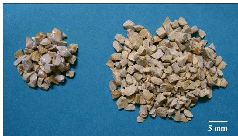
Abbildung 78: Getterfraktionen einer mit Natrium beladenen „Kao10“ Schüttung. Links: gläserne Pellets aus dem Eingang der Schüttung. Rechts: Pellets aus Mitte- und Ausgangsbereich der Schüttung
