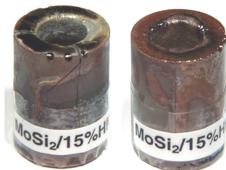
Abbildung 172: MoSi 2 -xHfO 2 -Tiegel nach dem Auslagerungsversuch
