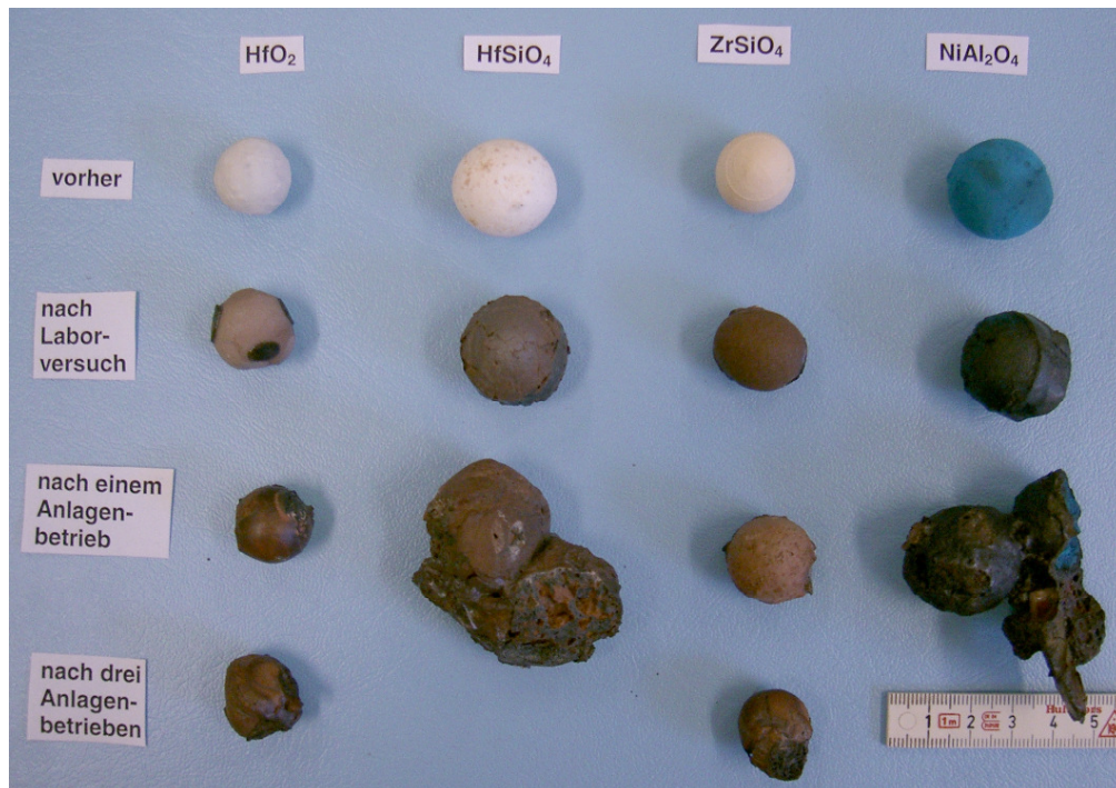
Abbildung 161: Technisch hergestellte Keramik-Kugeln vor und nach der Auslagerung in Schlacke im Labor (100 h, 1450 °C) und in der Versuchsanlage in Dorsten (ca. 200 bzw. 500 h Kohlebetrieb)
