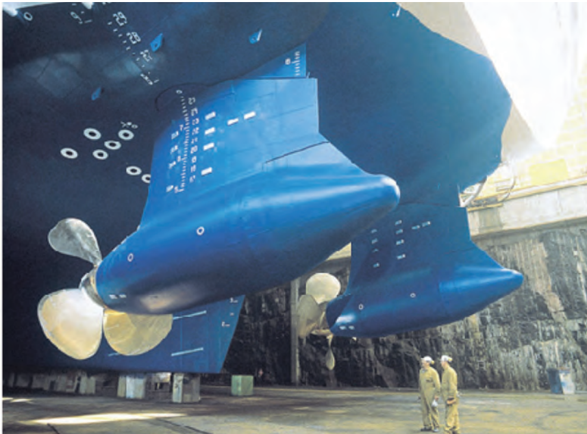
Bild 1: Pod-Antrieb der Firma ABB Marine, Helsinki
