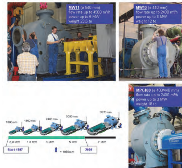
Abbildung 12 : Geplante und realisierte Multi- phasen-Pumpen- Baugrößen
