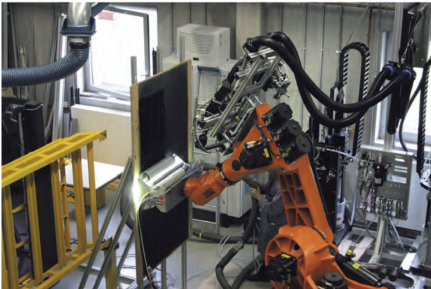
Abbildung 14: Applikator und senkrechte Roboterapplikation unter Laborbedingungen
