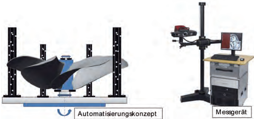
Abbildung 6: Messaufbau und -system für die Propellerprüfung
