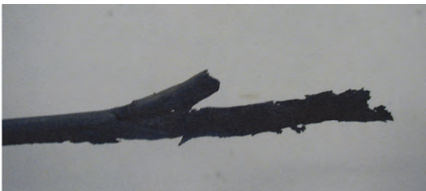
Abbildung 8: Durch explosive Dekompression geschädigter O-Ring
