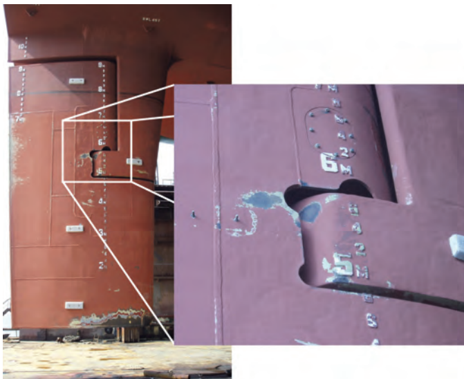
Halbschweberuder mit Kavitationsschäden im Pintle-Bereich
