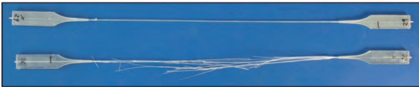
Abbildung 10: Rovingzugproben mit angegossenen Endlaschen vor und nach der Prüfung
