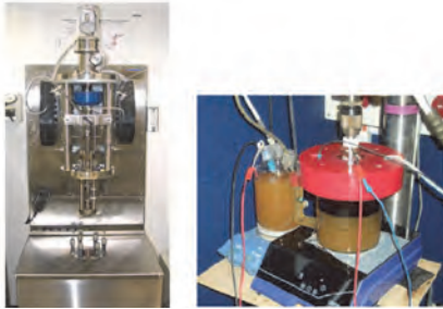
Abbildung 11: Hochdruck/temperatur SSRT Autoklav (l), Spaltkorrosionsmesszelle (r) zu MPP-spezifischen Korrosionsuntersuchungen
