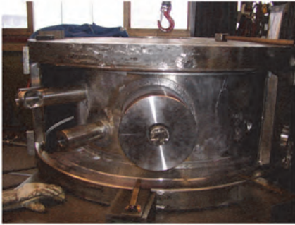
Abbildung 3: Pumpengehäuse aus 1.4462 Du- plex Stahl der Unterwasserpumpe UW-MPC268 teilgeschweißt für einen Betriebsdruck von 100bar
