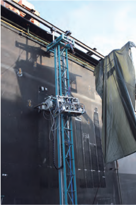
Abbildung 16: Applikation Riblet-Beschichtung unter Werftbedingungen
