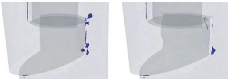
Isoflächen des Druckbeiwertes C_p = -2.3 als kavitationsgefährdeter Bereich beim idealen (links) und beim realen Ruder (rechts)
