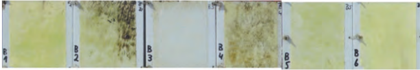
Abbildung 12: Biozidhaltige Ribletbeschichtungen nach mehreren Monaten statischer Auslagerung
