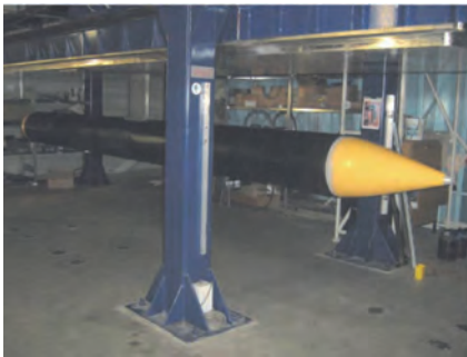
HYKAT-modul mit Messwaage und Probenkörper im Einbau (links), Feldbeule (rechts)
