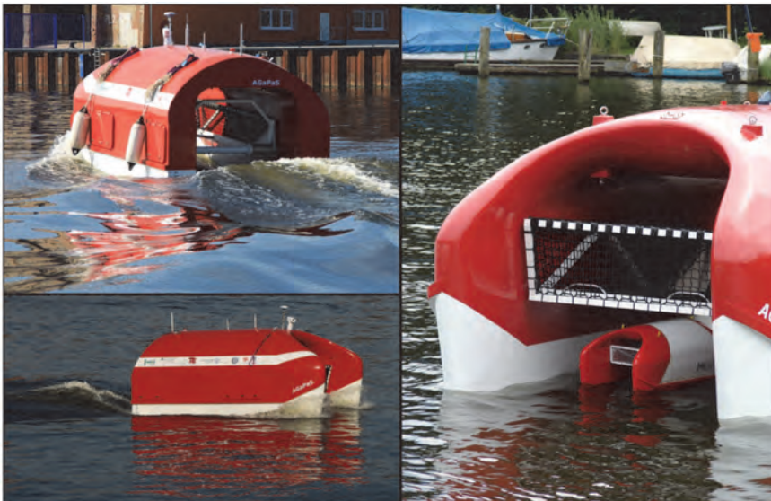
Abbildung 5.11: Großausführung (Länge: 4,5 m, Breite: 2,3 m, Rettungsbreite: 1,5 m, Tiefgang 0,5 m, Gewicht 1050 kg)
