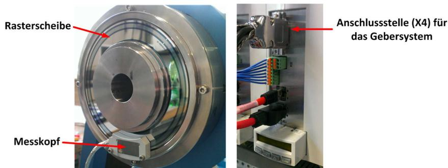
Abbildung 3.17: Motor mit Rasterscheibe und Messkopf.
