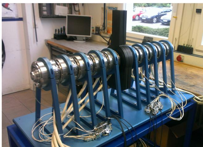
Abbildung 2.4: Mechanische Gesamtkonstruktion des Fächerchoppers.
