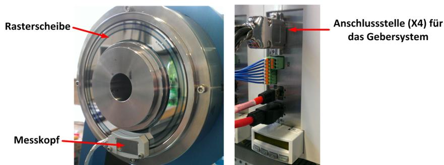
Abbildung 3.17: Motor mit Rasterscheibe und Messkopf.
