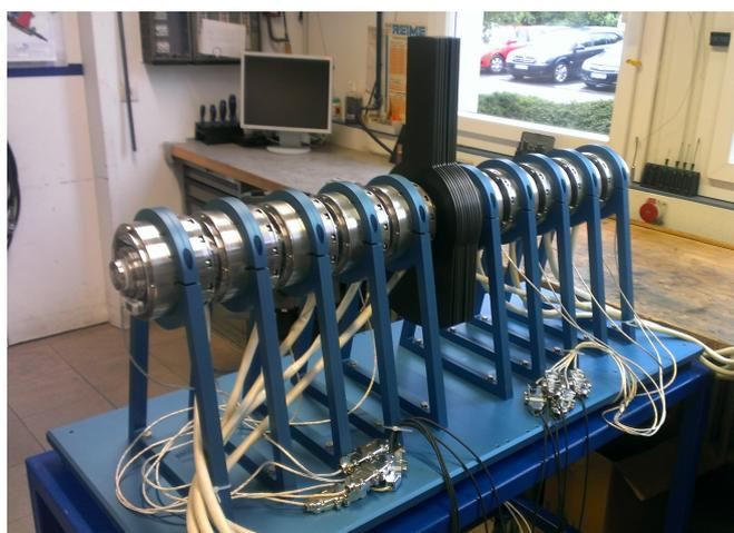
Abbildung 2.4: Mechanische Gesamtkonstruktion des Fächerchoppers.
