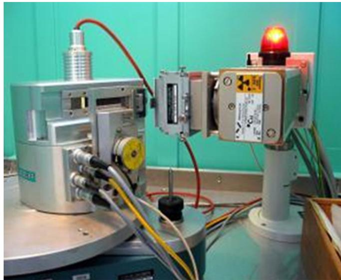
Abbildung 3.3: Pulverdiffraktometer des Typs Huber G670 [12]
